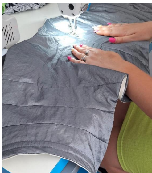
Slika 37: Prošivanje kanalića na korzetu za fišbajn
