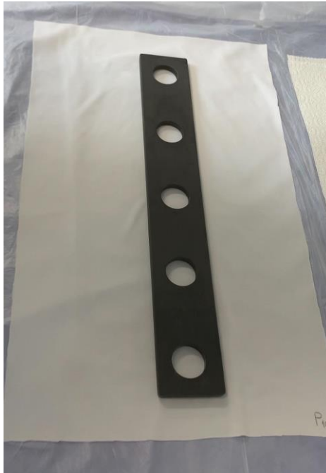
Slika 16: Okvir s rupicama za jednakomjerno nanašanje mrlja
