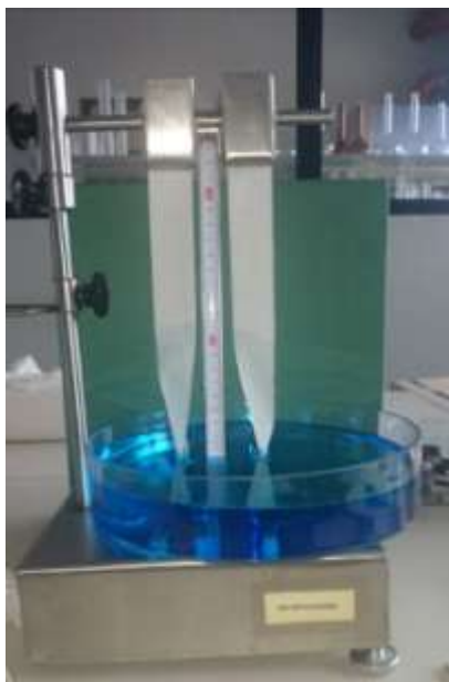
Slika 12. Aparatura za ispitivanje vertikalnog testa, prema normi ISO 9073-6:2000
