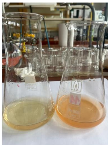
Slika 17. Argentometrijska titracija vodene otopine klorida niskih koncentracija ( < 100 \text{ mg dm}^{-3} )
