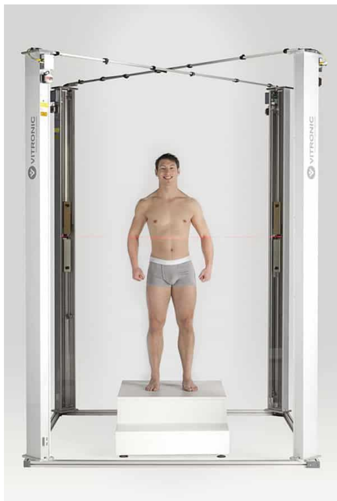
Sl.5. 3D skener Vitus Smart proizvođača Human Solutions [22]
