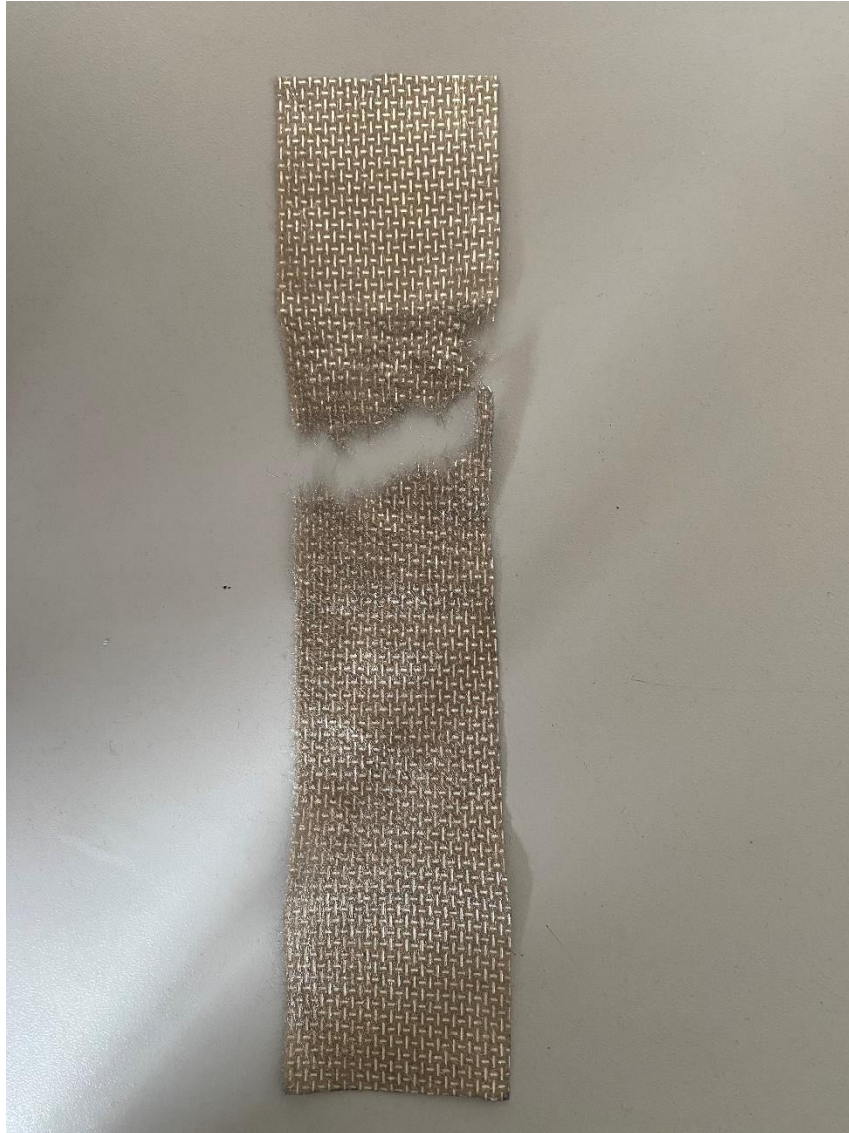
Slika 28: Uzorak u mokrom stanju nakon prekida na dinamometru
