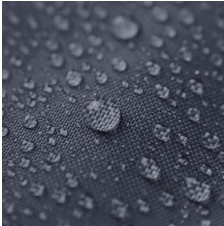
Slika 7. Nano premaz za postizanje vodoodbojnosti na tkanini [12]
