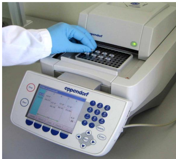
Slika 5: Detalj iz procesa detekcije GMO-a na bazi analize DNK pomoću standardnog PCR [15]
