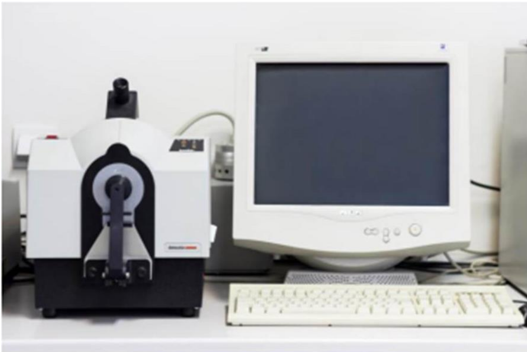
Slika 15. Remisijski spektrofotometar DataColor SP600 + CV UV [8]
