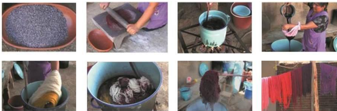
Slika 7. Proces bojadisanja tekstilnog materijala košenilom [13]
