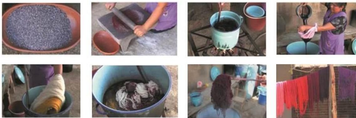
Slika 7. Proces bojadisanja tekstilnog materijala košenilom [13]
