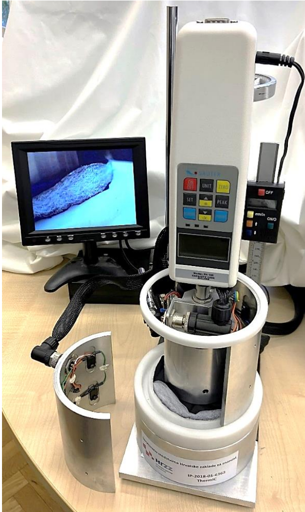
Sl. 36: Višenamjenski diferencijalni konduktometar za odjevne kompozite i odjeću
