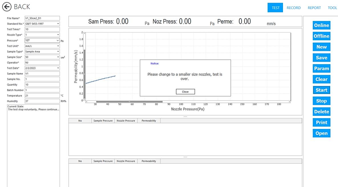
Sl. 23: Prikaz programskog sučelja mjernog uređaja za ispitivanja zrakopropusnosti TF164B, Testex nakon neu-spešno provedenog određivanja zrakopropusnosti na uzorku
