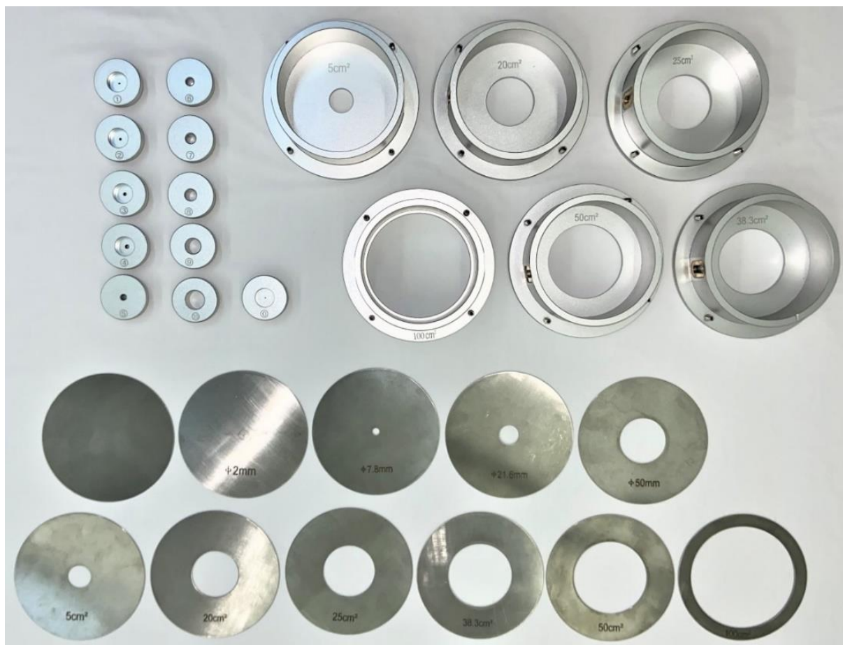
Sl. 22: Prikaz mlaznica, kalibracijskih ploča te mjernih glava mjernog uređaja za ispitivanje zrakopropusnosti TF164B, Testex
