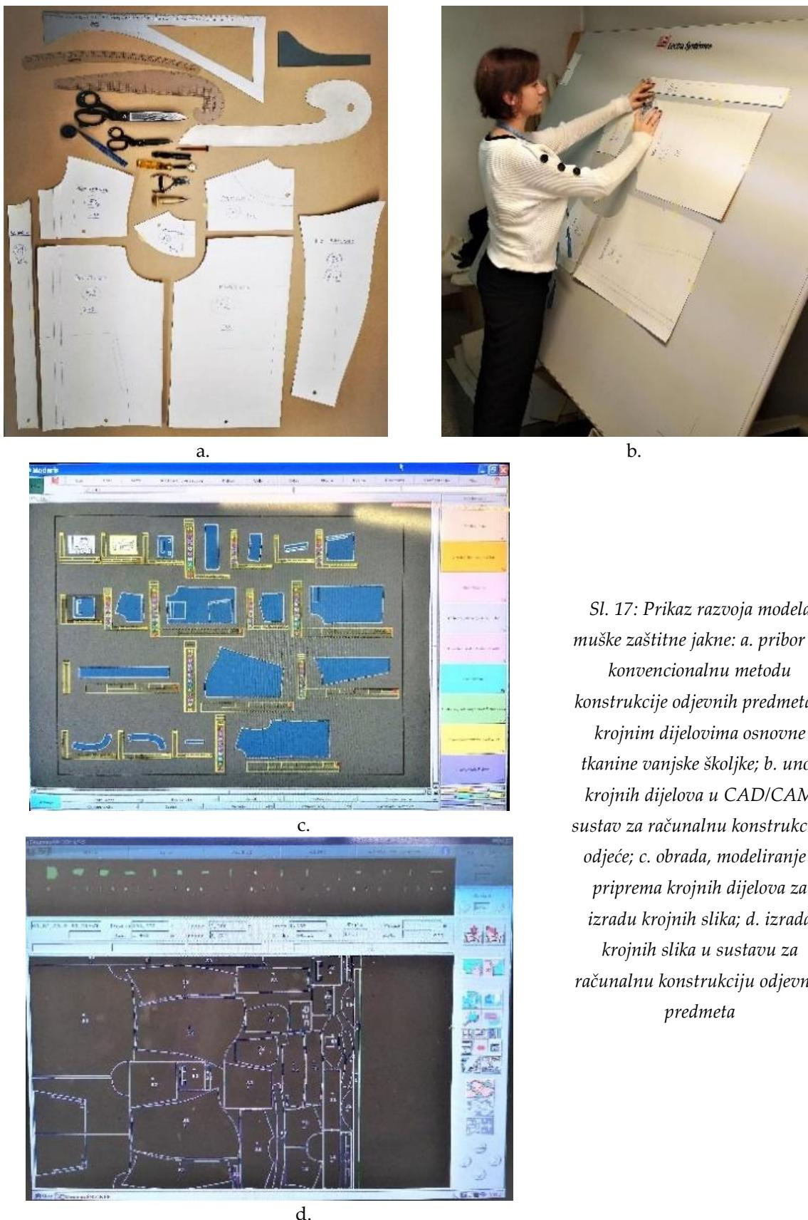
*Sl. 17: Prikaz razvoja modela muške zaštitne jakne: a. pribor za konvencionalnu metodu konstrukcije odjevnih predmeta s krojnim dijelovima osnovne tkanine vanjske školjke; b. unos krojnih dijelova u CAD/CAM sustav za računalnu konstrukciju odjeće; c. obrada, modeliranje i priprema krojnih dijelova za izradu krojnih slika; d. izrada krojnih slika u sustavu za računalnu konstrukciju odjevnih predmeta*
