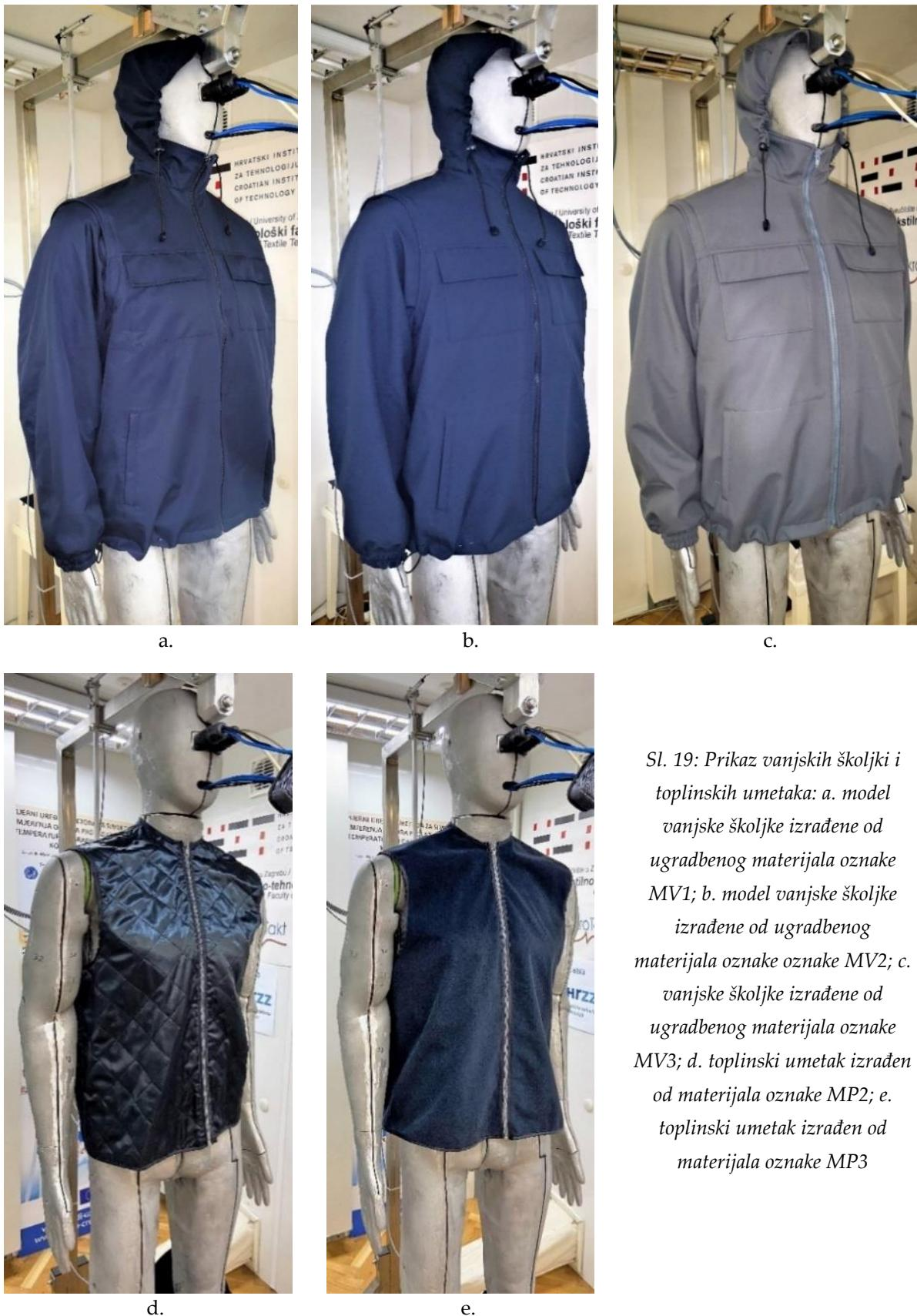
*Sl. 19: Prikaz vanjskih školjki i toplinskih umetaka: a. model vanjske školjke izrađene od ugradbenog materijala oznake MV1; b. model vanjske školjke izrađene od ugradbenog materijala oznake MV2; c. vanjske školjke izrađene od ugradbenog materijala oznake MV3; d. toplinski umetak izrađen od materijala oznake MP2; e. toplinski umetak izrađen od materijala oznake MP3*
