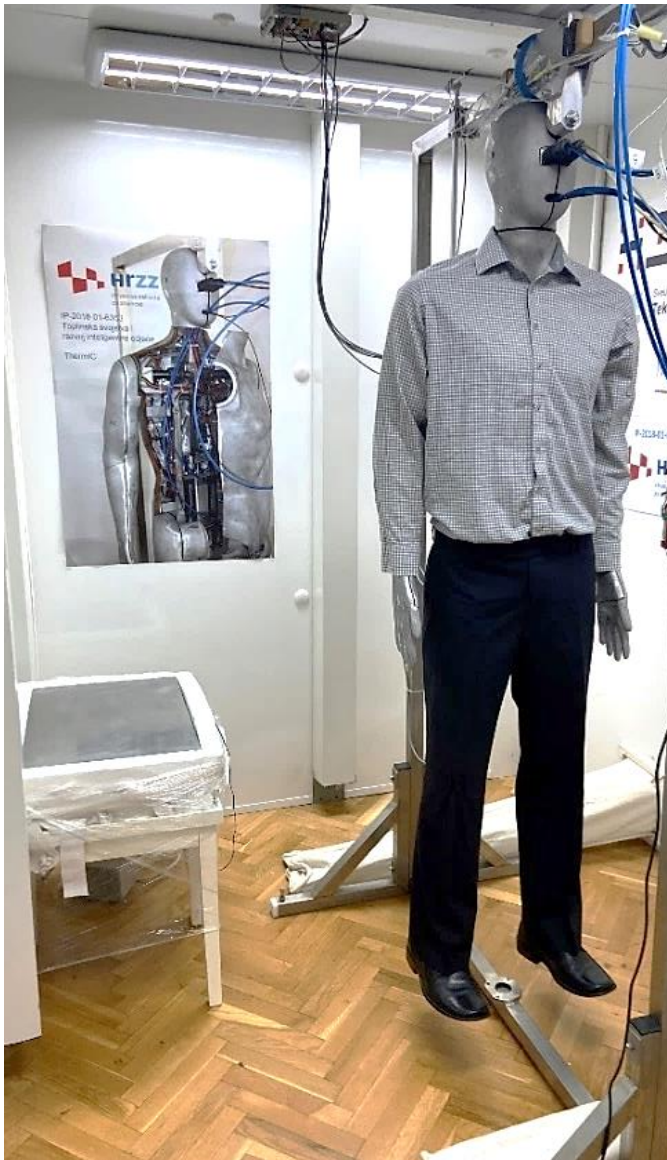
Sl. 26: Integrirani mjerni sustav za određivanje toplinskih svojstava odjevnih kompozita i odjeće
