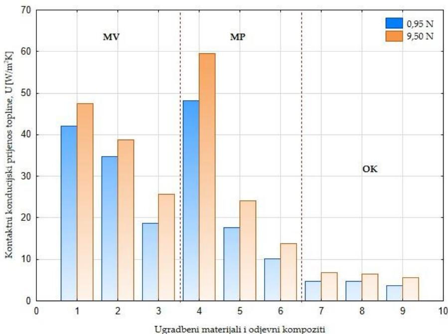
Sl. 84: Grafički prikaz rezultata određivanja kontaktnog konduktičkog prijenosa topline ugradbenih materijala i reprezentativnih odjevnih kompozita pri silama opterećenja od 0,95 N i 9,5 N
