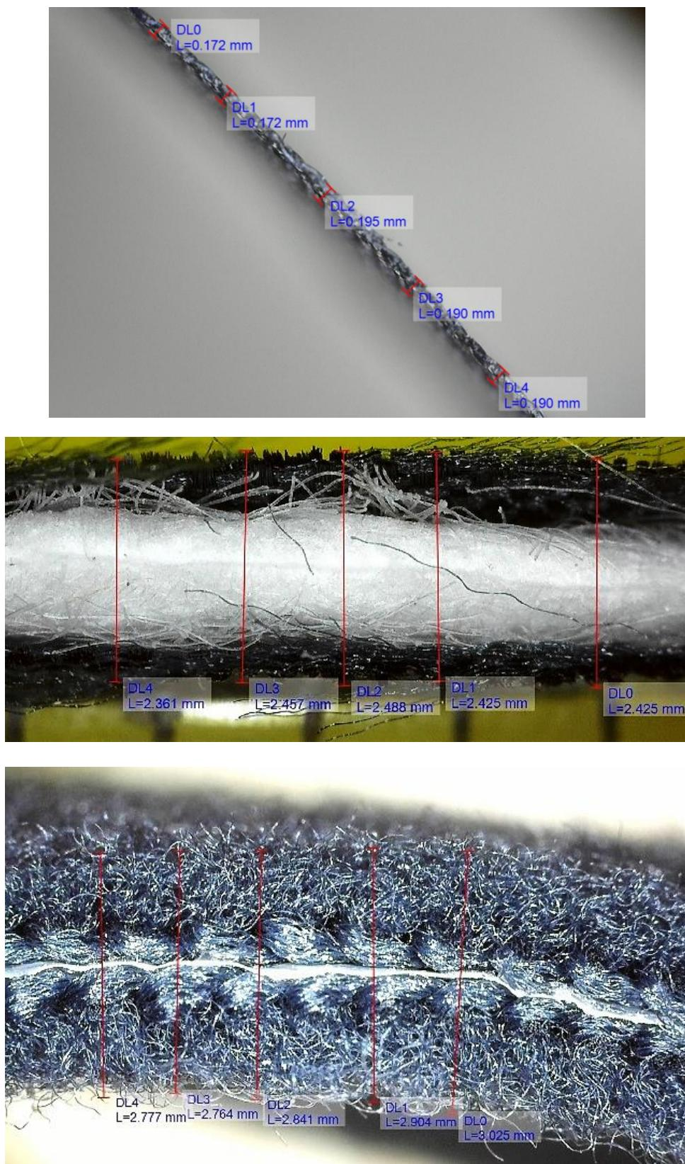
Sl. 39: Poprečni presjeci ugradbenih materijala s prikazanim vrijednostima mjerenja njihove debljine Dino-Lite digitalnim mikroskopom: a. dvoslojni laminirani materijal (MV1); b. troslojni laminirani materijal (MV2); c. troslojni laminirani materijal (MV3); d. podstavni materijal (MP1); e. romboidno prošivena podstava (MP2); f. micro-fleece materijal (MP3)
