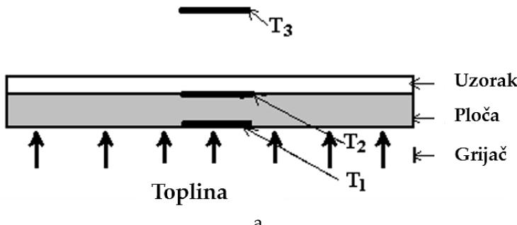
Sl. 8: Mjerni uređaj Togmetar: a. metoda s jednom pločom; b. metoda s dvije ploče (Uttam, 2012)
