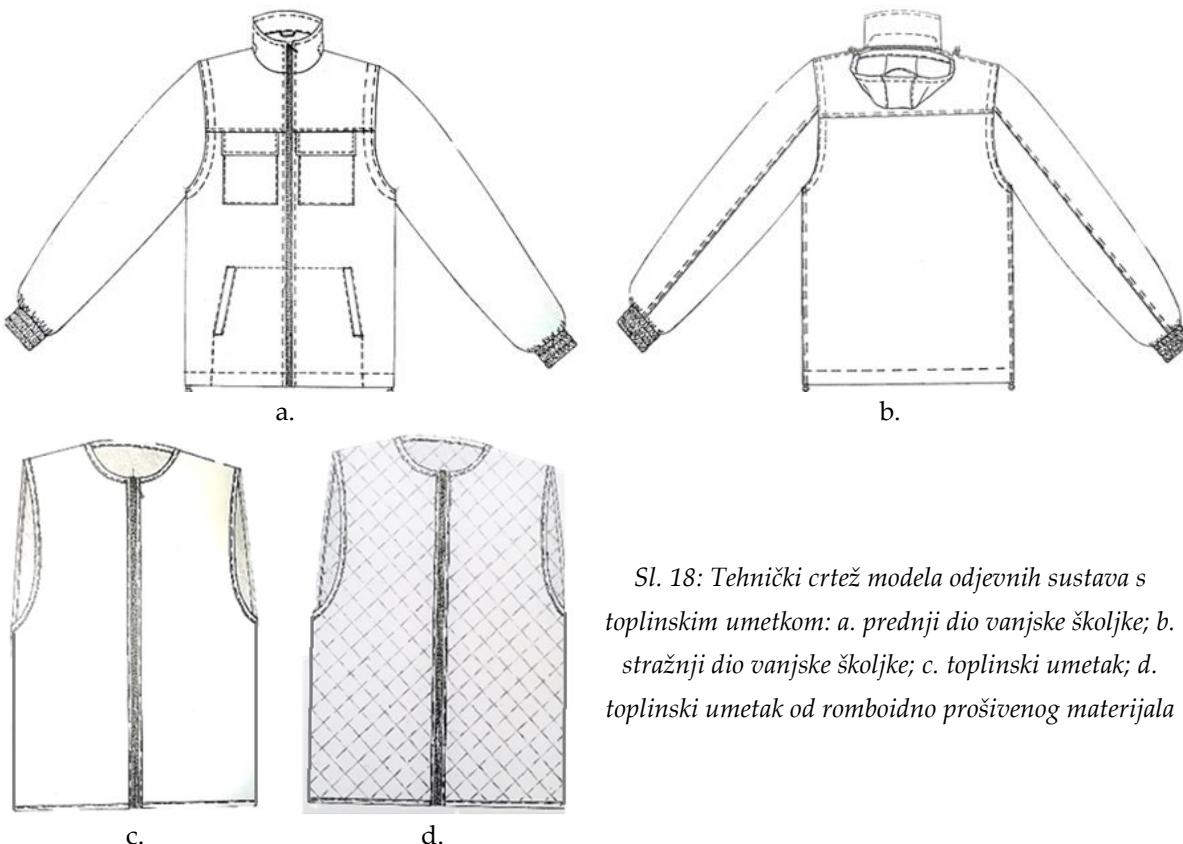
*Sl. 18: Tehnički crtež modela odjevnih sustava s toplinskim umetkom: a. prednji dio vanjske školjke; b. stražnji dio vanjske školjke; c. toplinski umetak; d. toplinski umetak od romboidno prošivenog materijala*
