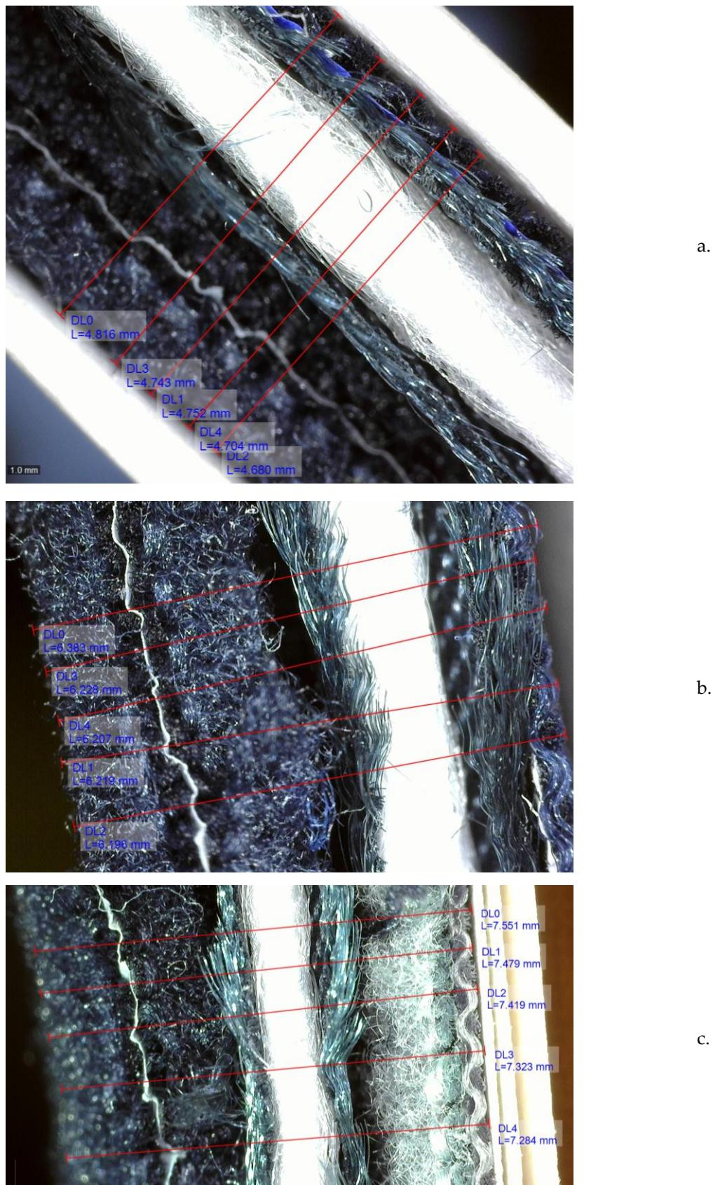
Sl. 40: Poprečni presjeci odjevnih kompozita s prikazanim vrijednostima mjerena njihove debljine Dino-Lite digitalnim mikroskopom: a. OK5 (MV1+MP2+MP3); b. OK10 (MV2+MP2+MP3); c. OK15 (MV3+MP2+MP3)
