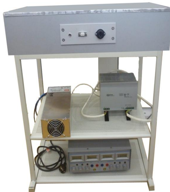
Sl. 27: Vruća ploča za određivanje otpora prolazu topline odjevnih kompozita
