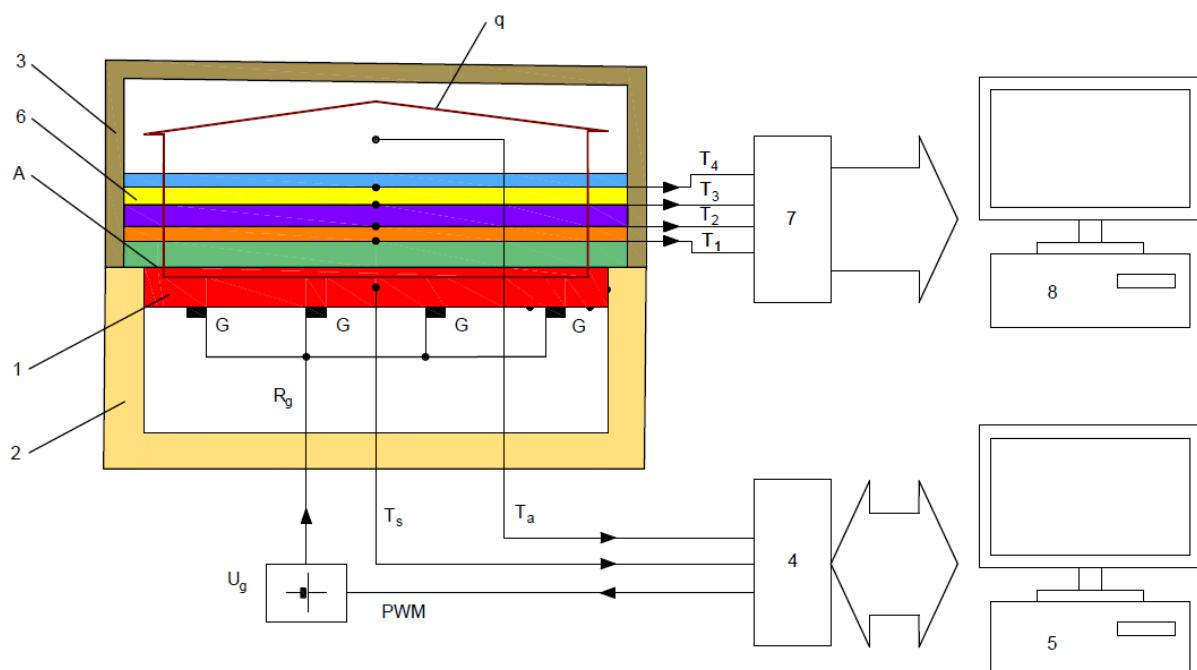
Sl. 34: Uredaj za mjerjenja temperaturnih gradijenata u odjevnim kompozitim i odjeći (Firšt Rogale et al., 2021)
