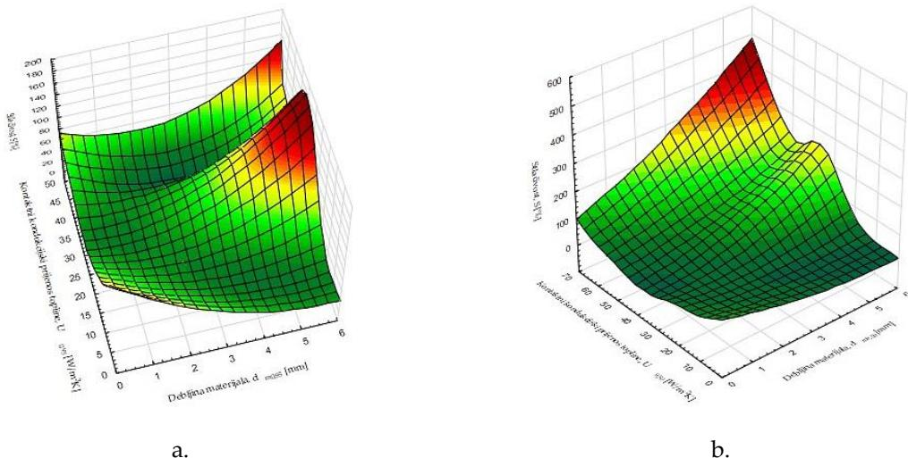
Sl. 88: Ovisnost kontaktnog konduksijskog prijenosa topline o debljini i stlačivosti materijala: a. pri sili opterećenja od 0,95 N; b. pri sili opterećenja od 9,50 N
