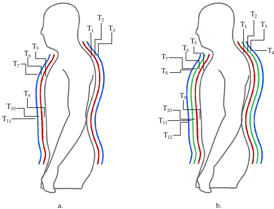
Sl. 82: Grafički prikaz pozicioniranja temperaturnih senzora tijekom mjerjenja provedenih na tri pozicije odjevnih sustava (leđa, prsa i struk): a. pozicija temperaturnih senzora na dvoslojnima odjevnim sustavima, b. pozicija temperaturnih senzora na troslojnima odjevnim sustavima
