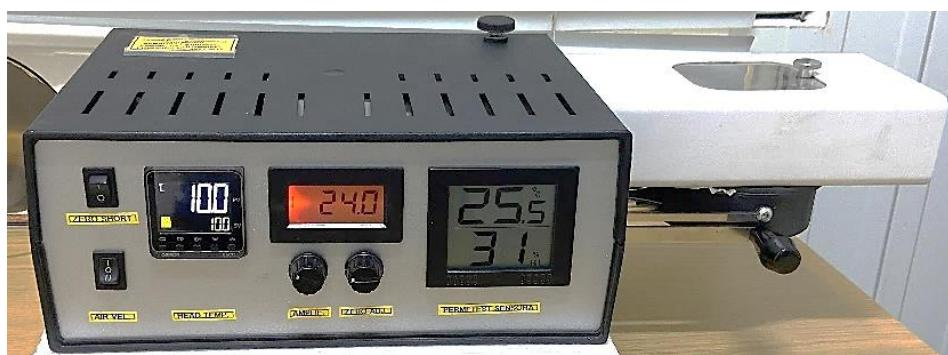
Sl. 24: Uredaj za nedestruktivno mjerjenje otpora prolazu topline, propusnost vodene pare i otpora prolazu vodene pare, Permetest
