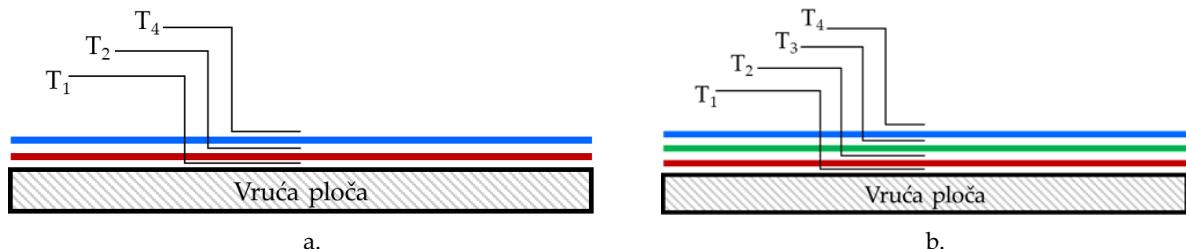
Sl. 80: Grafički prikaz pozicioniranja temperaturnih senzora tijekom mjerjenja provedenih na ugradbenim materijalima i odjevnim kompozitim: a. pozicija temperaturnih senzora na dvoslojnima odjevnim kompozitima, b. pozicija temperaturnih senzora na troslojnima odjevnim kompozitima
