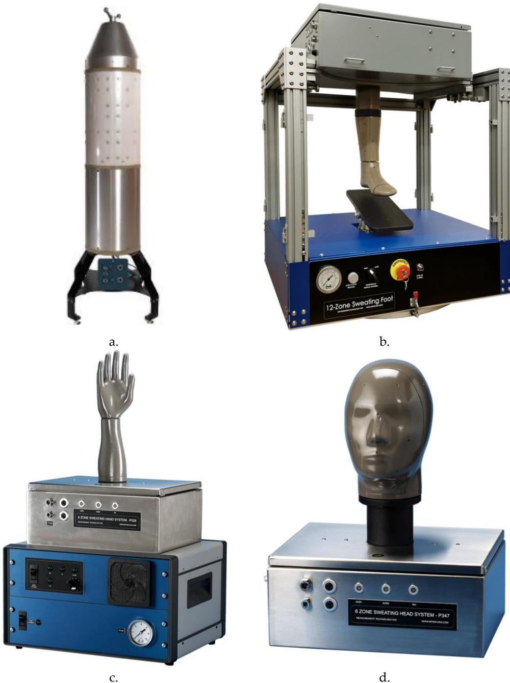
Sl. 12: Prikaz anatomske oblikovanih mjernih uređaja za mjerjenje toplinske izolacije: a. toplinski torzo; b. toplinsko stopalo; c. toplinska ruka i d. toplinska glava (Thermetrics, 2020)
