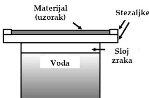
Sl. 11: Prikaz ispitivanja propusnosti vodene pare tzv. metodom čaše (McCullough, Kwon & Shim, 2003)
