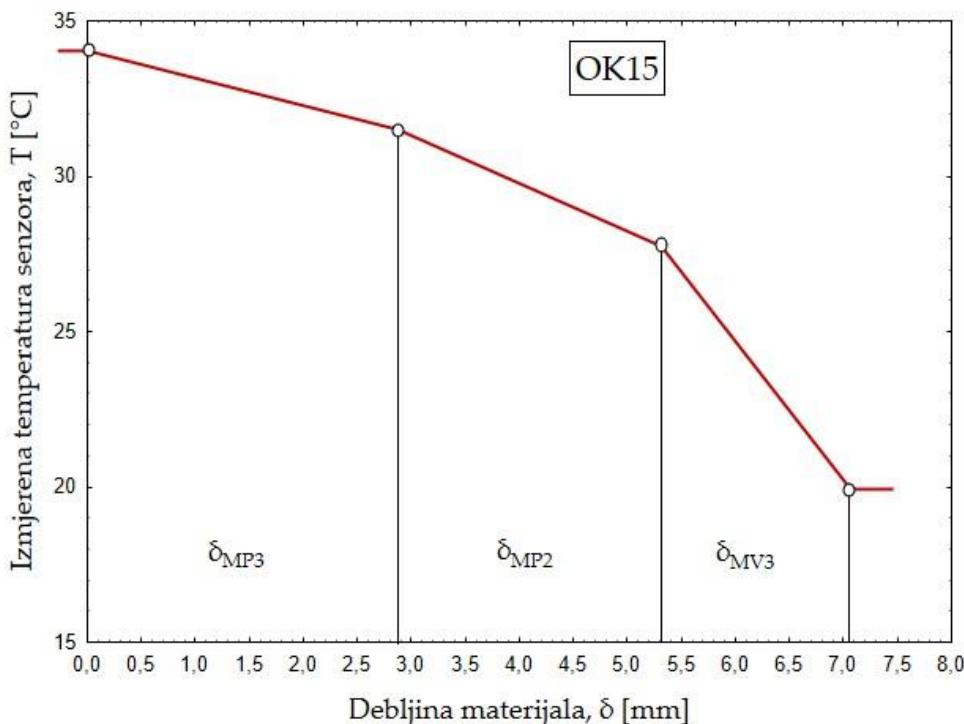
Sl. 81: Grafički prikaz rezultata određivanja diferencijalnih gradijenata temperatura reprezentativnih odjevnih kompozita: a. OK5; b. OK10; c. OK15
