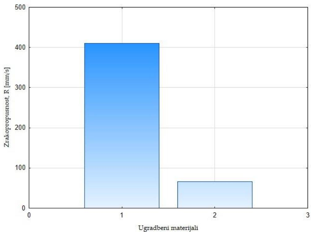
Sl. 41: Grafički prikaz rezultata mjerena zrakopropusnosti ugradbenih materijala
