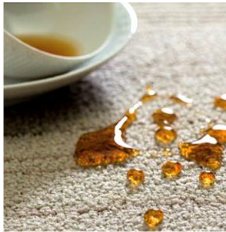
Slika 14. Odbojnost tekstilnog materijala na djelovanje tekućine
