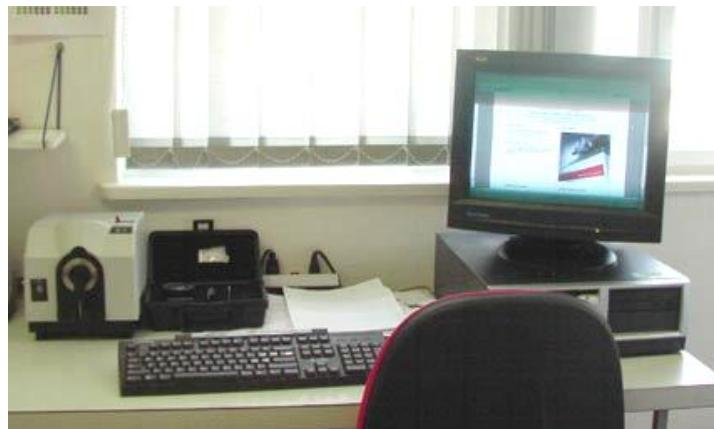
**Slika 18.** Remisijski spektrofotometar Spectraflash SF 300, tt. Datacolor [i]
