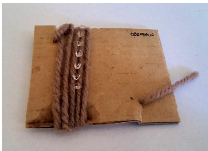
Slika 31. Izgled i ponašanje kapi na obrađenom uzorku V1
