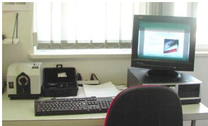
Slika 18. Remisijski spektrofotometar Spectraflash SF 300, tt. Datacolor [i]
