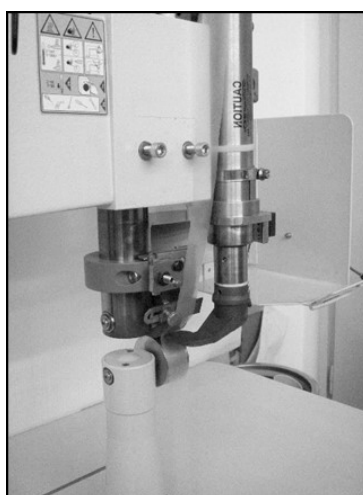
Sl. 2.13 Prikaz dijela stroja za spajanje spaja pomoću toplinske konvekcije tt. Pfaff
