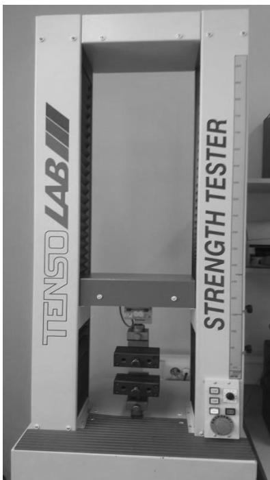
Sl. 3.20 Prikaz kidalice Tensolab 3000 proizvođača Mesdan S.p.A
