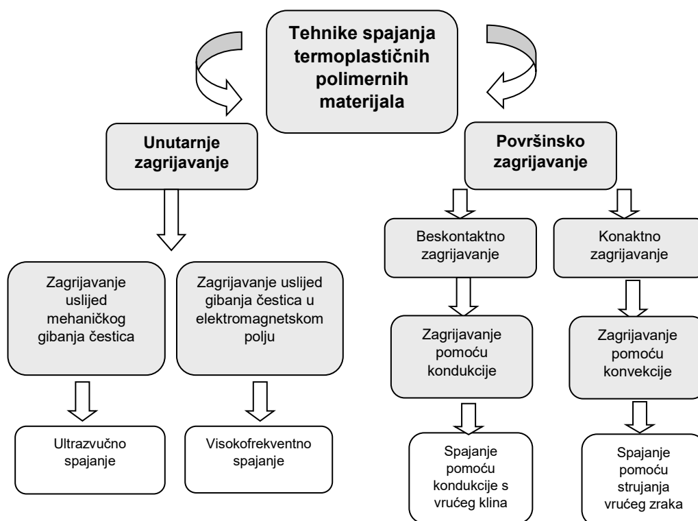
Sl. 2.1 Podjela tehnika spajanja prema načinu dovođenja i/ili induciranja topline u termoplastičnom polimernom materijalu
