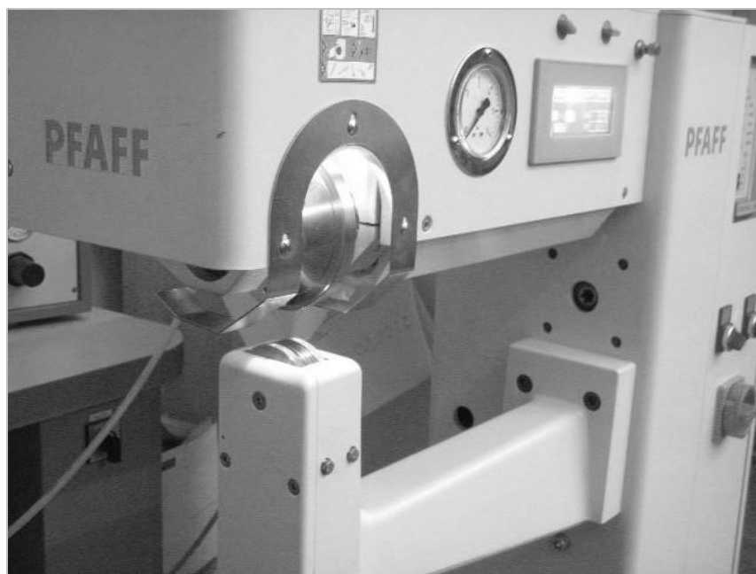
Sl. 3.5 Stroj za ultrazvučno spajanje proizvođača Pfaff oznake Seamsonic 8310-003
