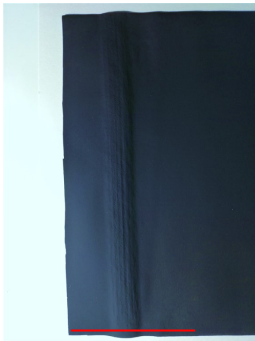
Sl. 5.3 Prikaz spoja na uzorku materijala oznake M13 spojenog pomoću vrućeg klina i istežanje materijala pri kraju spoja u području spoja
