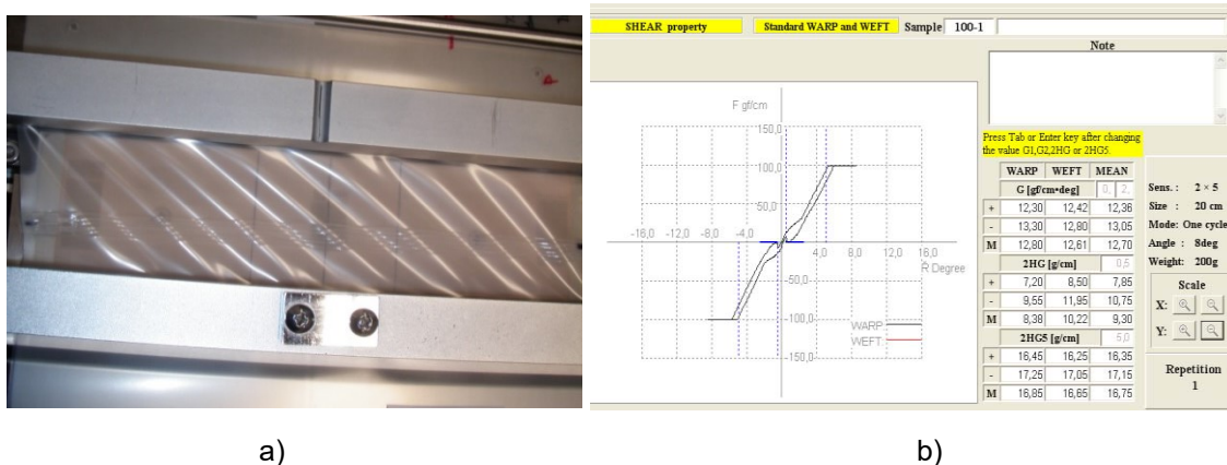
Sl. 5.1 Mjerenje smičnih svojstava a) izgled uzorka oznake M10 za vrijeme mjerenja smičnih svojstava; b) vrijednosti mjerenja uzorka materijala oznake M10 bez spoja u jednom sloju.
