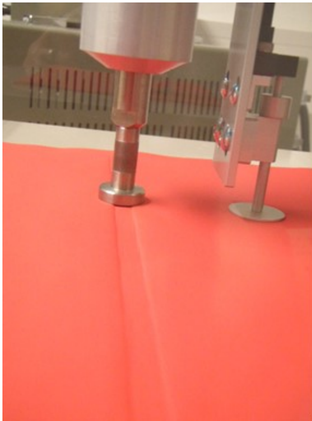
Sl. 4.56 Mjerenje kompresijskih svojstava
