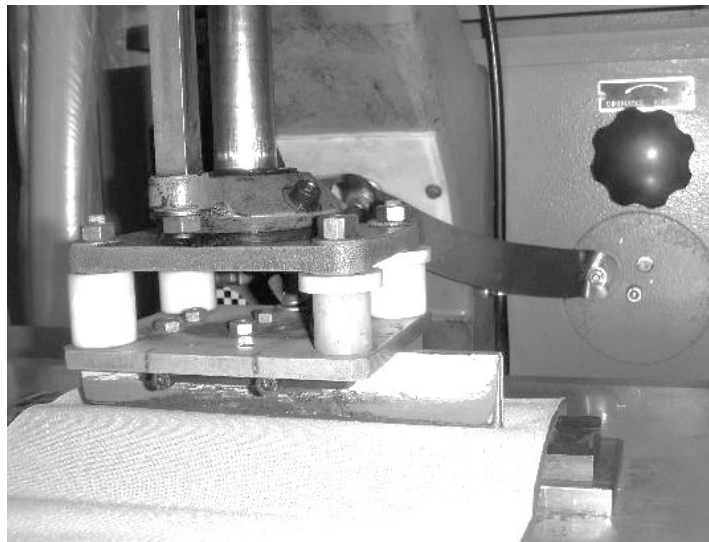
Sl. 3.8 Prikaz dijela stroja za visokofrekventno spajanje te gornje i donje visokofrekventne elektrode
