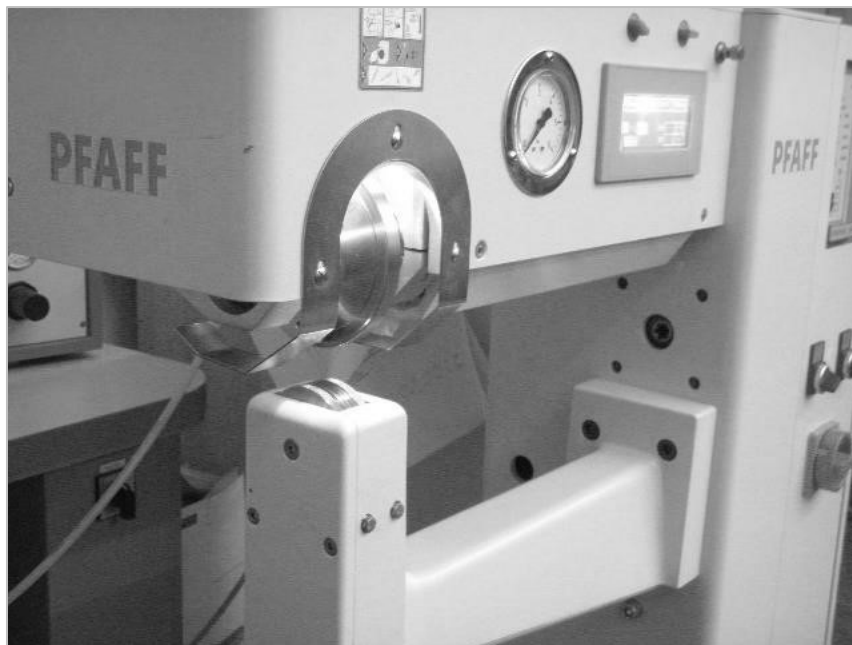
Sl. 3.5 Stroj za ultrazvučno spajanje proizvođača Pfaff oznake Seamsonic 8310-003
