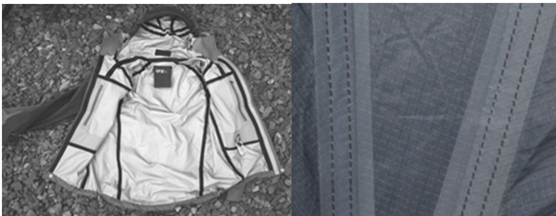
Sl. 2.14 Primjena tehnike spajanja toplinskom konvekcijom, spajanjem adhezivne trake po šavu
