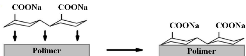
Slika 22 Shematski prikaz adsorpcije CMC na površinu polimera [103]
