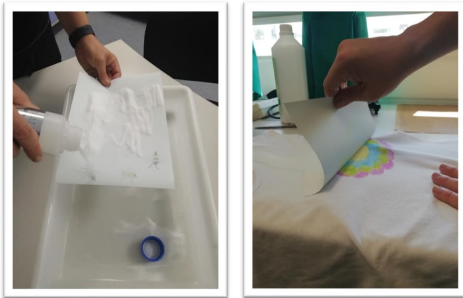
Slika 7 i 8: posipavanje stabilizacijskog praha i uklanjanje transfer papira [28] [29]
