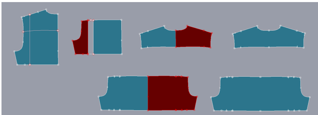
Slika 36: Modeliranje gornjeg dijela zaštitnog kombinezona 1
