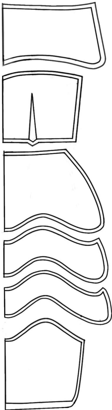
Slika 47. krojni dijelovi i šavni dodaci prednjeg dijela
