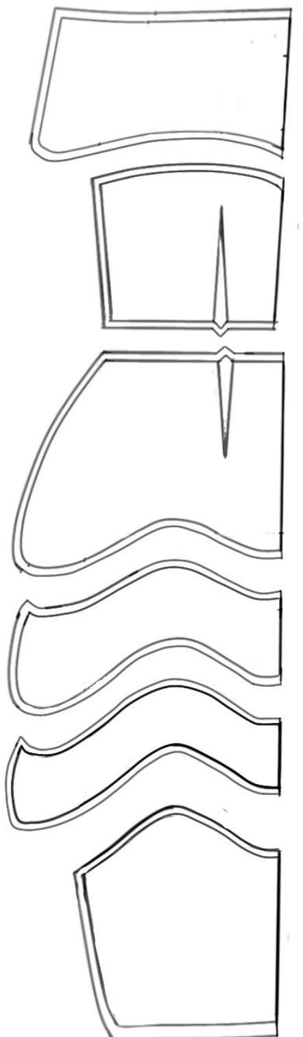
Slika 46. krojni dijelovi i šavni dodaci stražnjeg dijela
