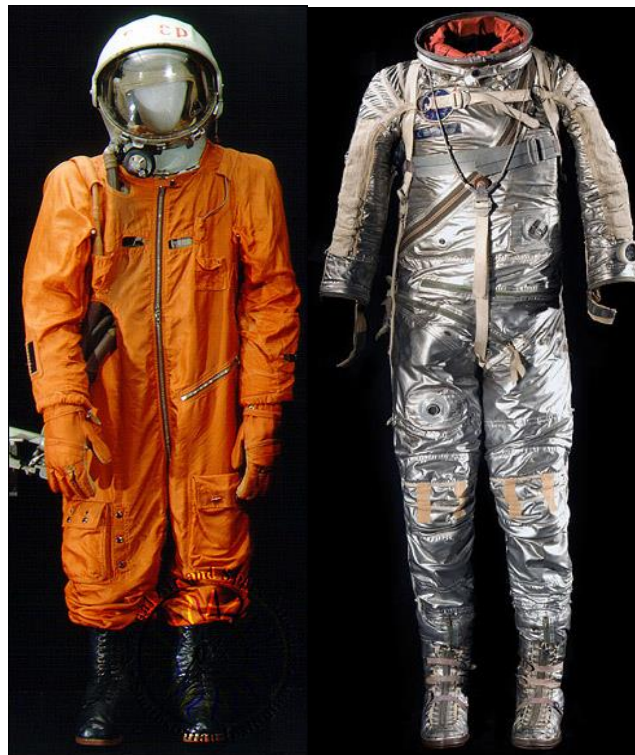
Slika 12. a), b): Odiijelo SK1 Jurija Gagarina od narančastog PA 6.6. i odijelo od Mylara .
