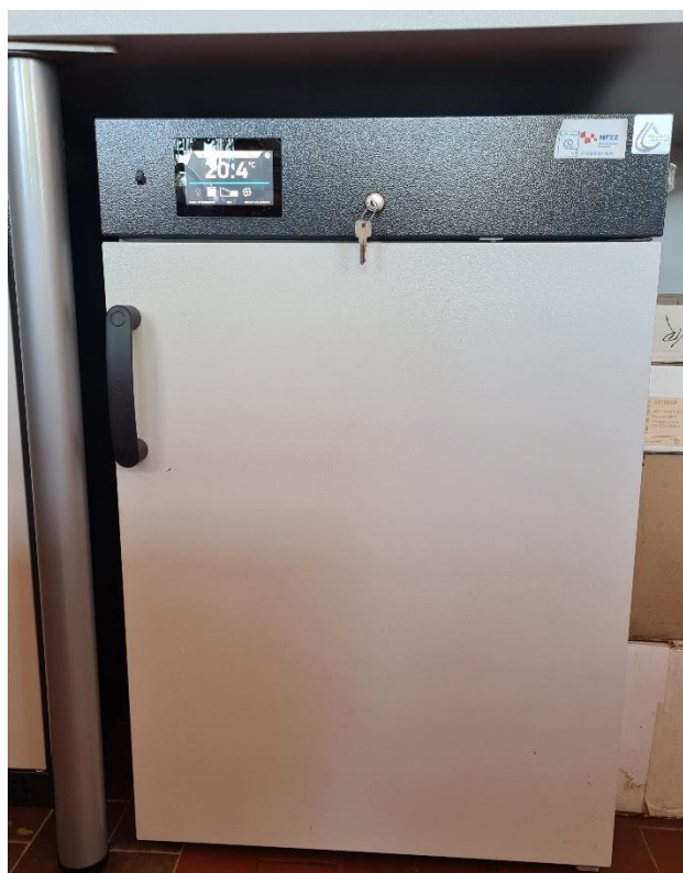
Slika 12. Inkubator Inkubator za BPK ST 2 BD SMART, Pol-Eko
