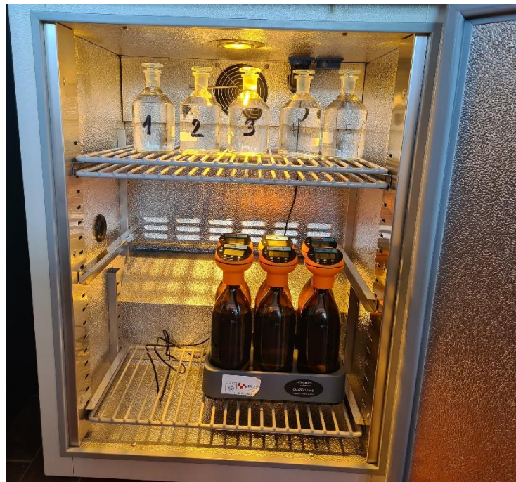
Slika 15. Boce za inkubaciju na magnetskoj mješalici u inkubatoru
