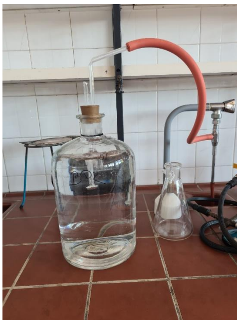
Slika 13. Aeriranje vode za razrjeđivanje
