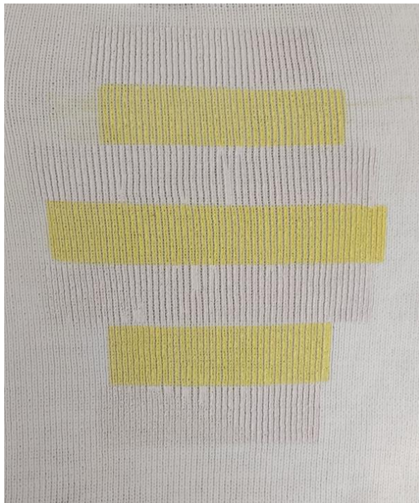
Slika 27.a. Izgled otiska na uzorku br.2 pletiva u opuštenom stanju [35]
