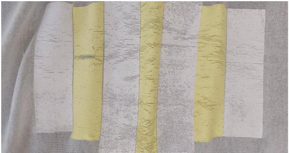
Slika 33.b. Izgled otiska na uzorku br.8 pletiva prilikom rastezanja pletiva [48]
