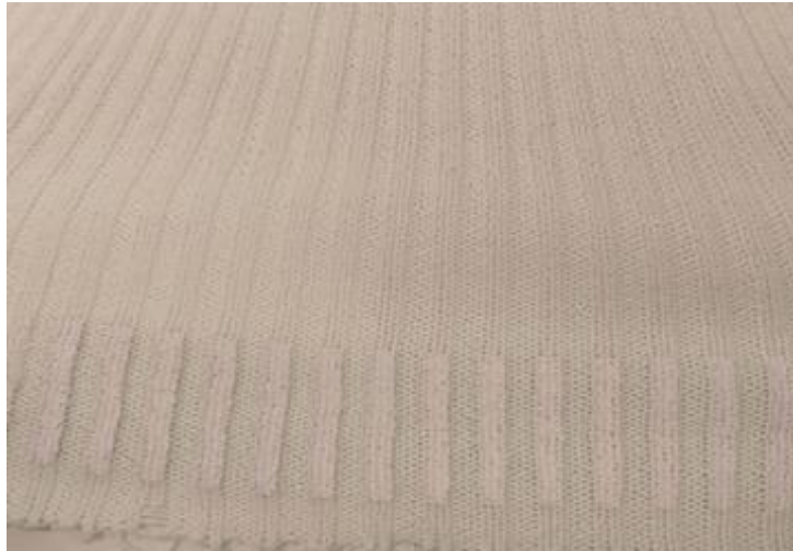
Slika 16. Površinski otisak na rebrima rebrastog pletiva [19]
