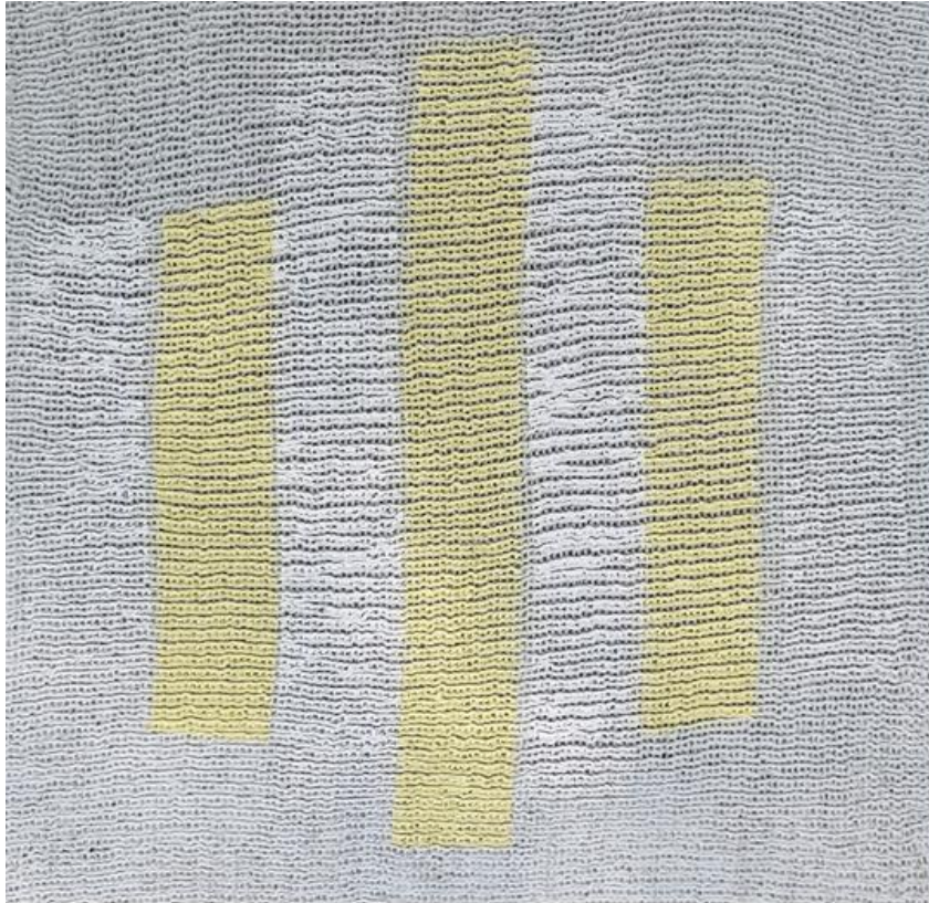
Slika 32.a. Izgled otiska na uzorku br.7 pletiva u opuštenom stanju [45]
