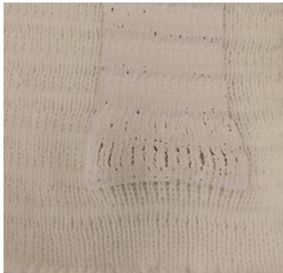
Slika 19. Pucanje otiska prilikom razvlačenja pletiva koje je otisnuto u opuštenom stanju [22]
