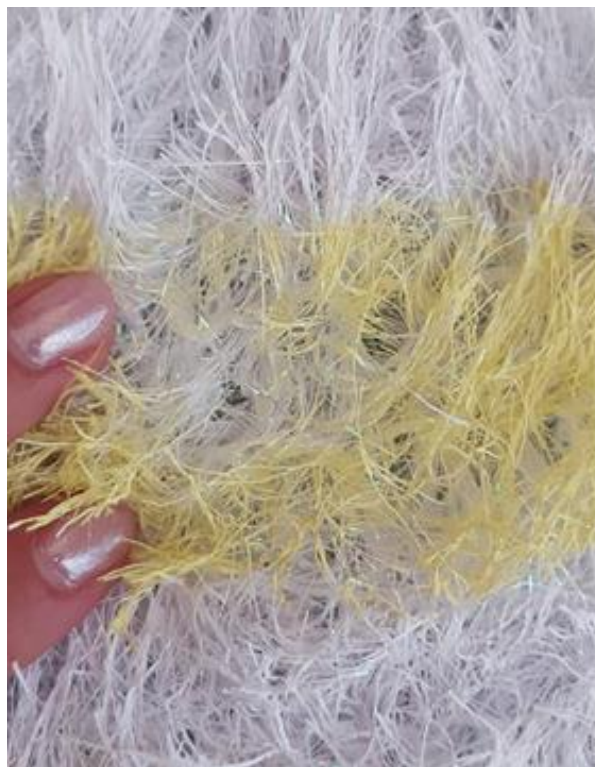
Slika 28.b. Površinski prodor tiska na uzorku br.3 pletiva s efektom pređom [38]
