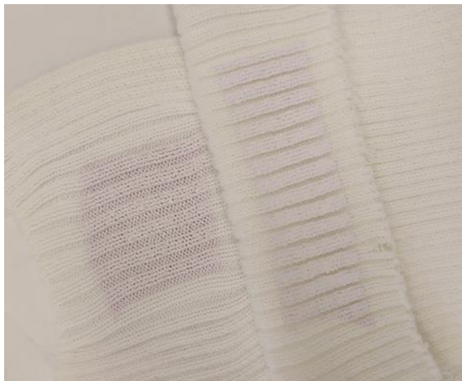
Slika 17. Oisak na uzorcima rebrastog pletiva u rastegnutom (lijevi uzorak) i opuštenom stanju (desni uzorak) [20]
