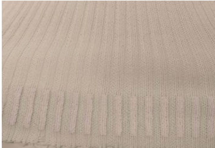
Slika 16. Površinski otisak na rebrima rebrastog pletiva [19]
