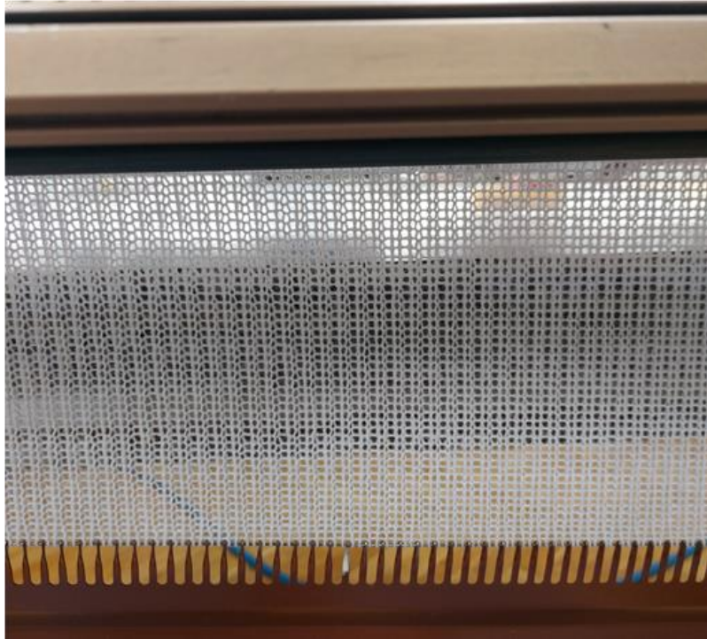
Slika 13. Uzorak 1. desno- desno glatko pletivo [14]
