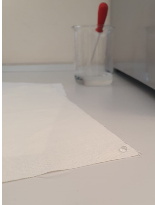
Sl. 31. Hidrofoban materijal vune prije obrade plazmom
