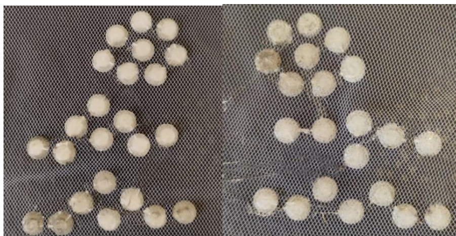
Slika 41. Ojačanja 3D tiskana TPU filamentom
