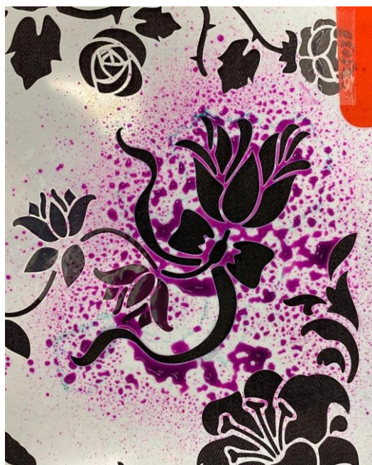
Slika 15. Nanošenje otopine \text{KMnO}_4 raspršivanjem
