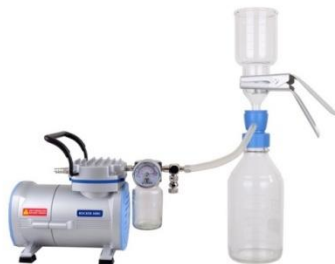
Slika 21. Uređaj za membransku filtraciju, Duran [44]
