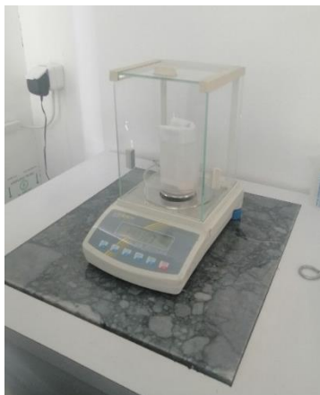
Slika 12. Vaganje uzoraka na približnu masu od 38 g (fotografirala K. Wolff)
