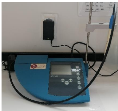
Slika 25. Konduktometar, CG 853, Schott (fotografirala K.Wolff)
