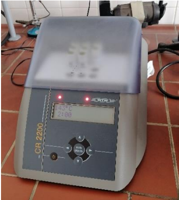
Slika 26. Termoreaktor CR 2200, WTW (fotografirala K.Wolff)
