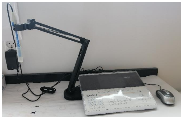
Slika 24. pH metar, SI Analytics, ProLab 3000 (fotografirala K.Wolff)
