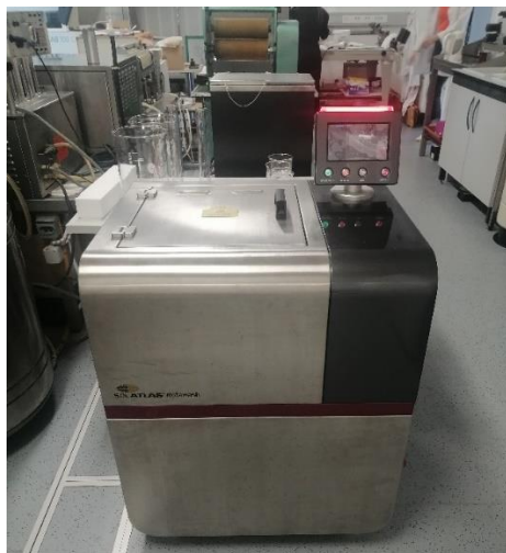
Slika 14. SDL ATLAS Rotawash (M228B/C) (fotografirala K.Wolff)
