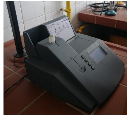
Slika 28. Fotometar photoLab S6, WTW (fotografirala K.Wolff)
