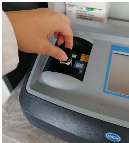
Slika 23. Stavljanje kivete u turbidimetar (fotografirala K.Wolff)
