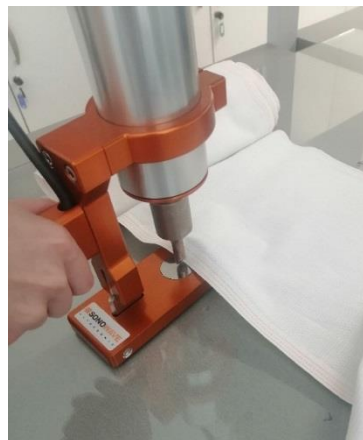
Slika 13. Rezanje uzorka ultrazvučnim nožem (fotografirala K. Wolff)
