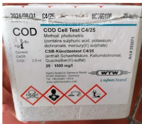
Slika 20. COD Cell Test C4/25 za provođenje mjerenja KPK vrijednosti
