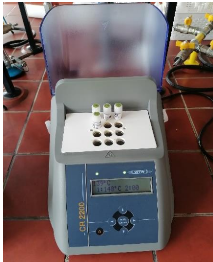
Slika 21. Termoreaktor za provođenje reakcije reflusiranja
