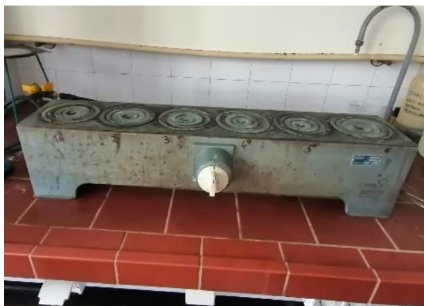
Slika 15. Prikaz vodene kupelji (lijevo) te sušionika (desno).
