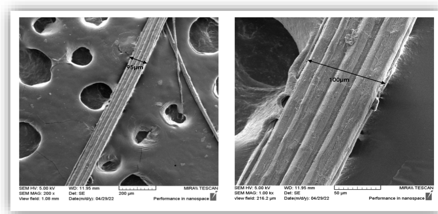
Slika 32. SEM snimka uzdužnog presjeka vlakna SH
