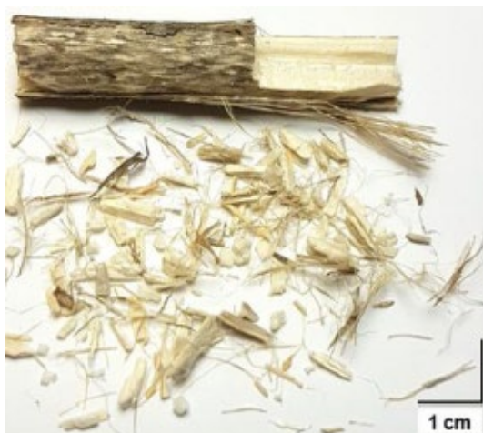
Slika 5. Prikaz sirovog materijala SH prije i nakon drobljenja [37]
