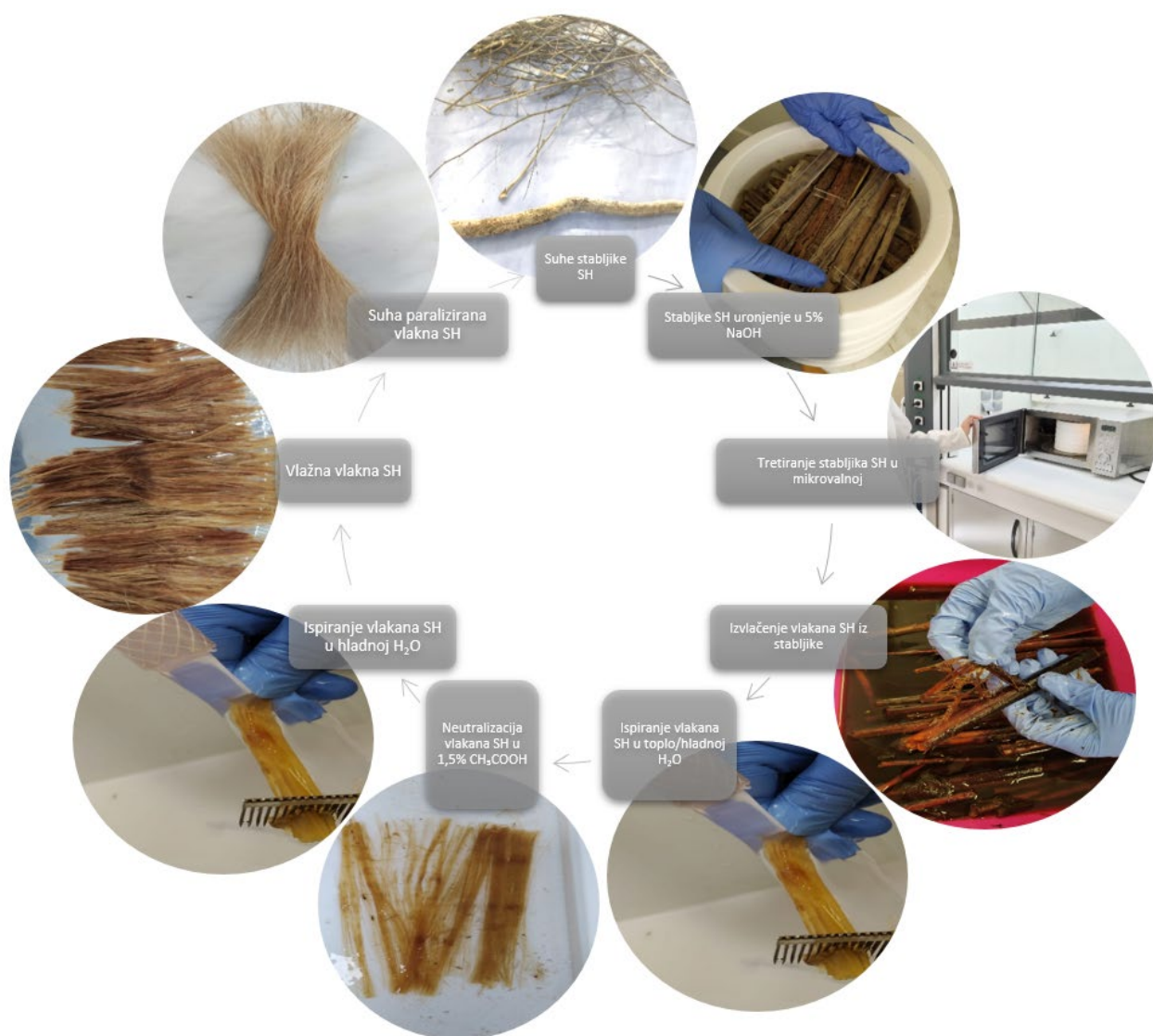
Shema 2. Shematski prikaz koraka alkalne maceracije SH pod utjecajem mikrovalne energije
