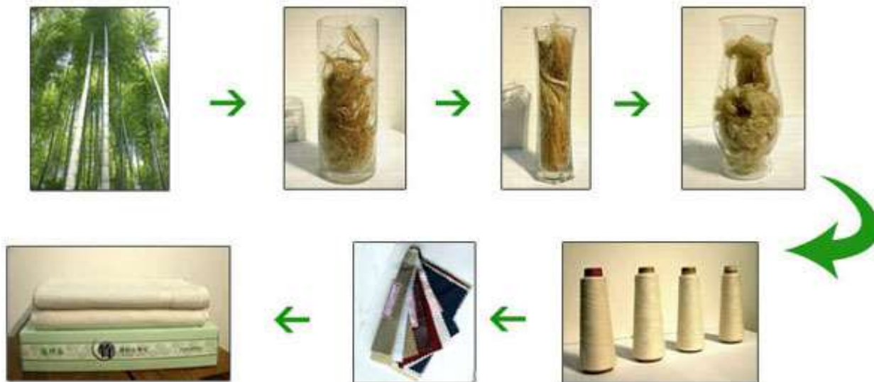
Slika 11 Od biljke do vlakna bambusa
