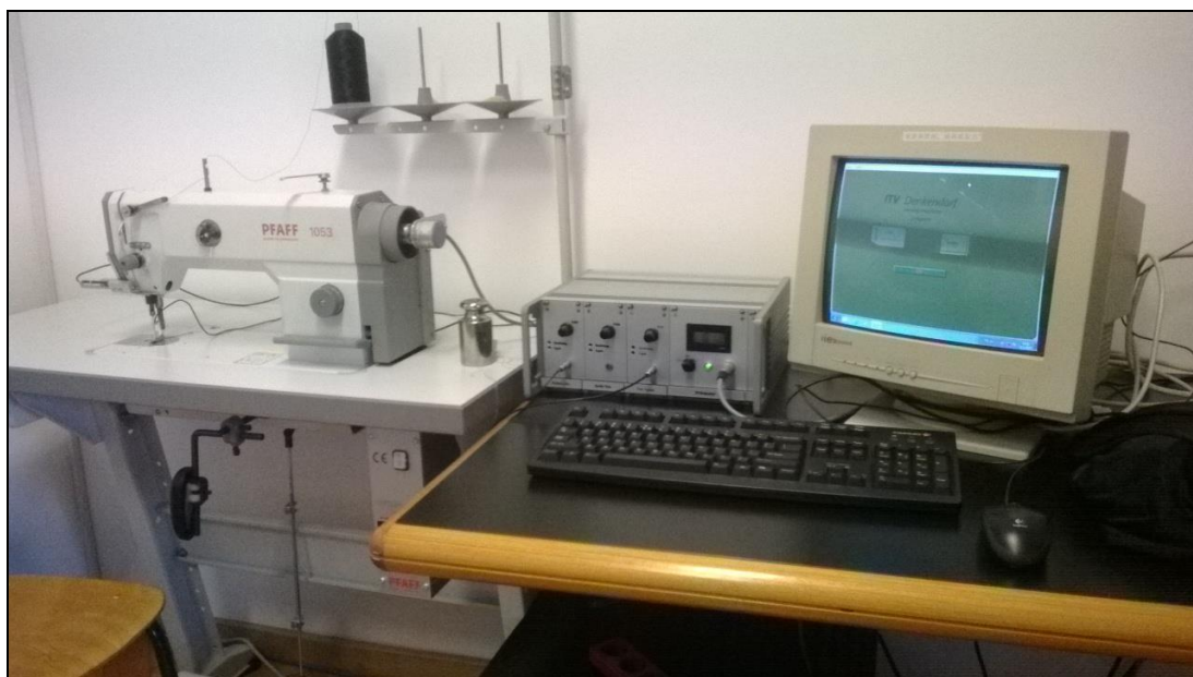
Sl.61 Mjerni uređaj za mjerenje probodne sile šivaće igle na šivaćem stroju koji se nalazi na Tekstilno-tehnološkom fakultetu u Sveučilišta u Zagrebu
