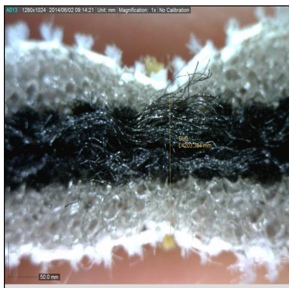
Sl. 114 Poprečni presjek kompozita na šivanom mjestu
