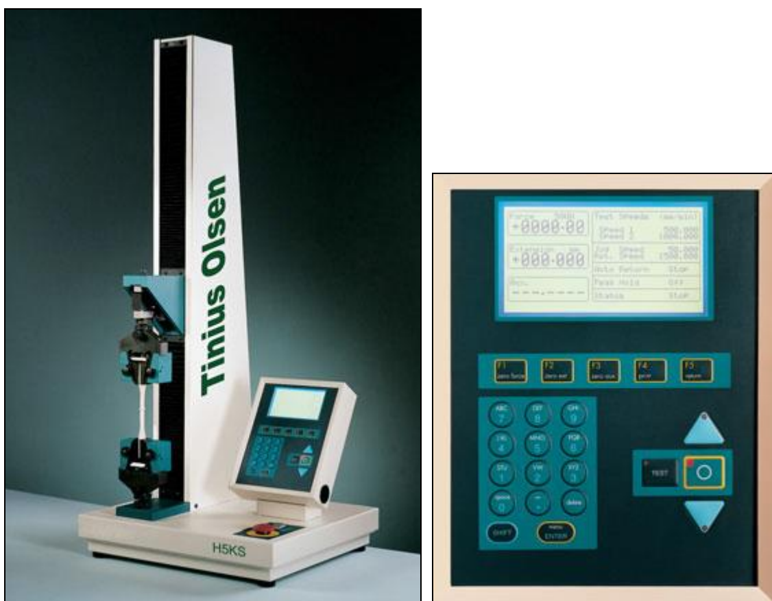
Sl. 54 Dinamometar Pellizzato/Tinius Olsen, Tip. H5KS
