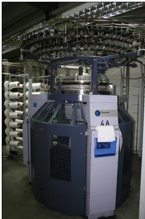
Sl.51 Pletaći stroj tt. Terrot tip: S296-1; E28 30``.
