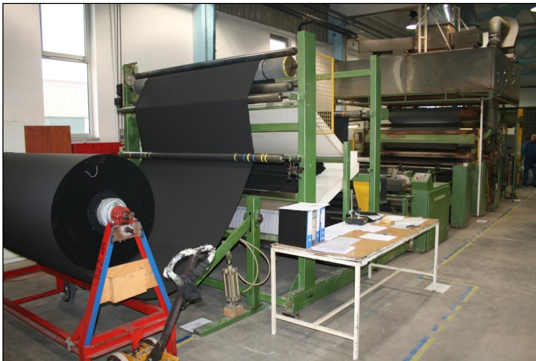
Sl. 52 Stroj za lijepljenje komponenata u kompozit sa plinskim plamenikom tt. Schmid, model: 1281/2200
