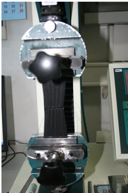
Sl.67 Prekidna sila i prekidno izduženje na šavu
