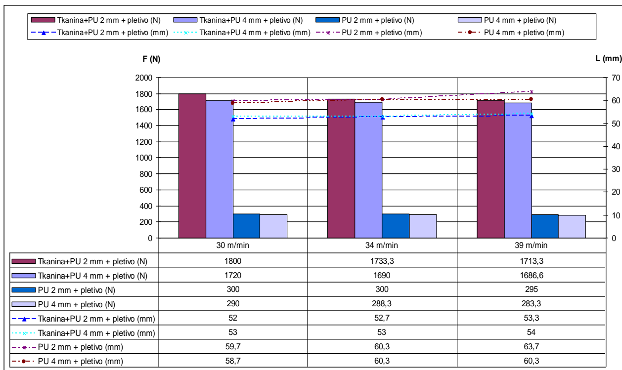
Sl. 103 Sile probijanja s promjerom kugle 10 mm i istežanje do prekida
