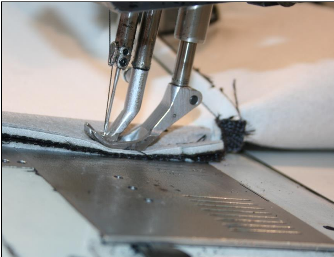
Sl.44 Sila pritiskne nožice na dva sloja materijala
