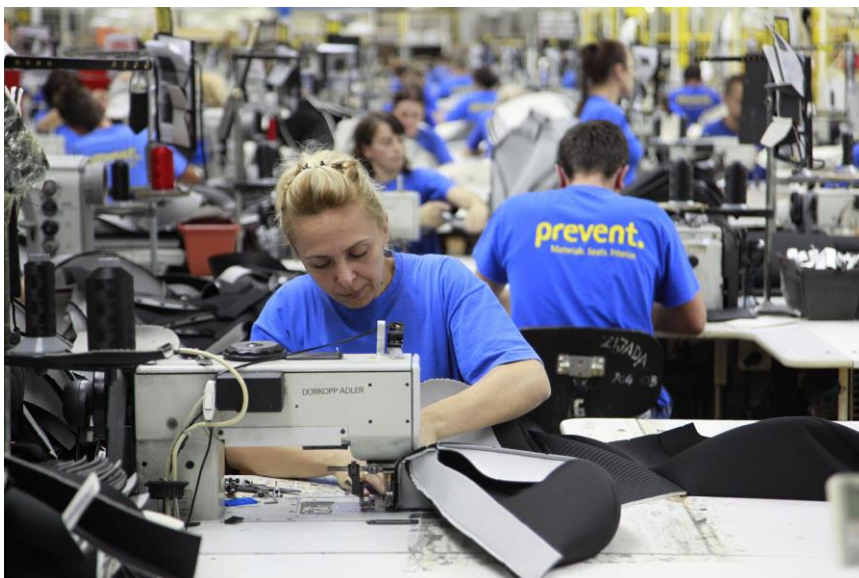
Sl. 5 Šivanje auto navlaka za sjedala u automobilima na šivaćem stroju tt. Durkopp Adler
