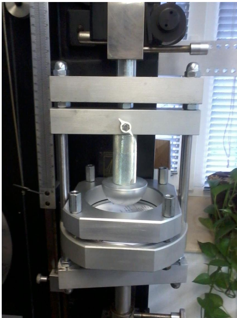
Sl. 68 Uređaj za probijanje kompozita do prekida s različitim promjerima kugle (60, 40, 20, 10 mm), a istim promjerom prstena (100 mm)
