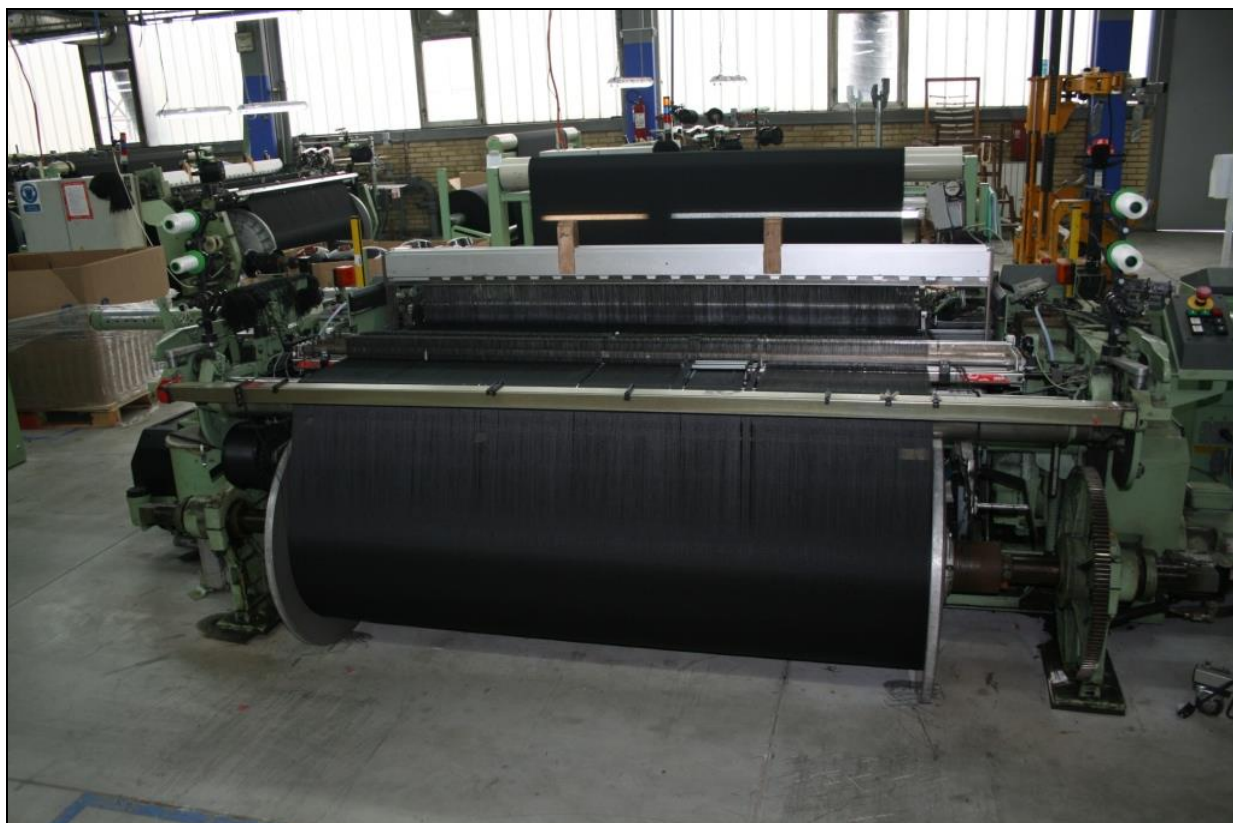
Sl.50 Tkalački stroj sa unosom potke pomoću hvatala i elektronskom listovkom tt. Dornier tip: S 220 cm,
