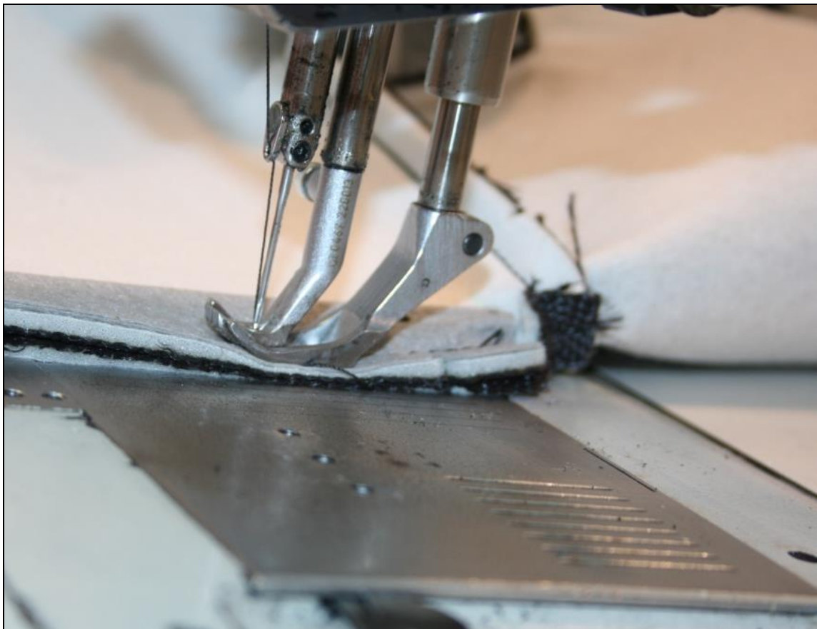
Sl.44 Sila pritisne nožice na dva sloja materijala
