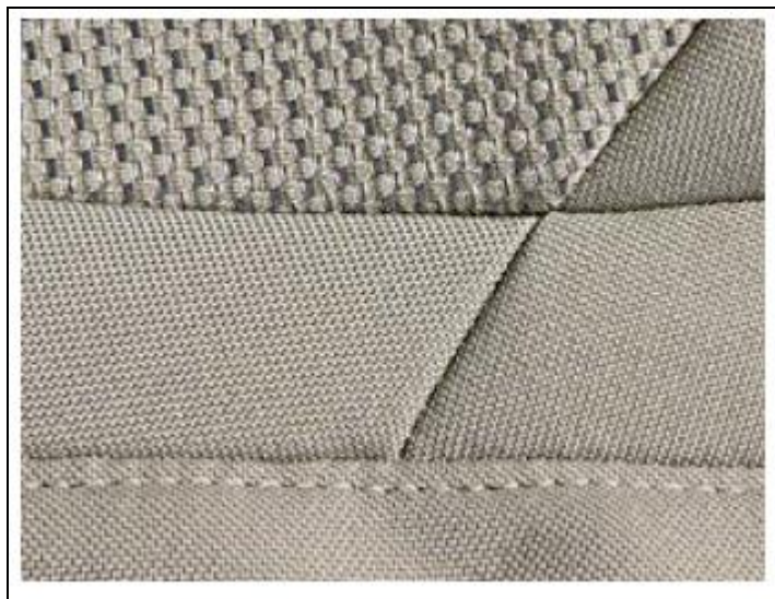
Sl. 26 Uporabna i estetska svojstva auto navlake ovisi o kvaliteti šava
