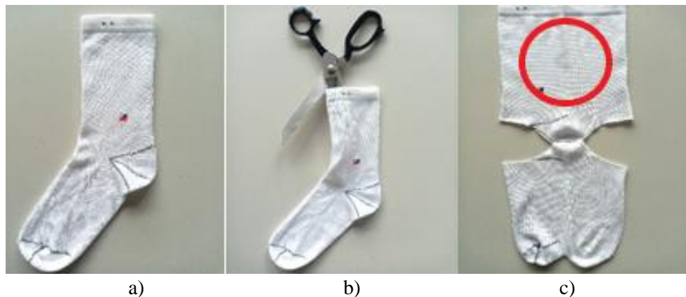
Slika 18. Priprema uzorka čarape za ispitivanje: a) cijela čarapa, b) razrezivanje čarape, c) čarapa pripravljena za uzorkovanje pletiva (crveni krug – uzorak za ispitivanje pilinga)
