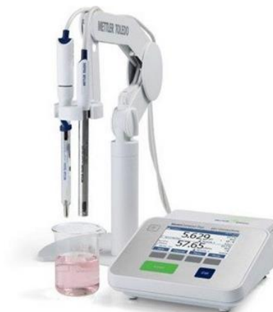
Slika 33. Multimetar SevenCompact™ Duo S213
