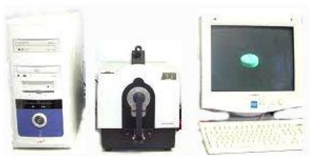
Slika 34. Remisijski spektrofotometar Spectraflash SF 300
