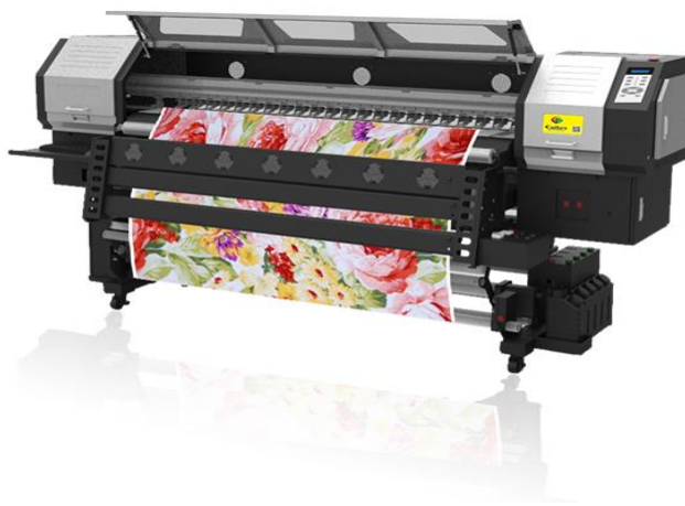
Slika 12: Digitalni pisac sa sublimacijskim bojilima
