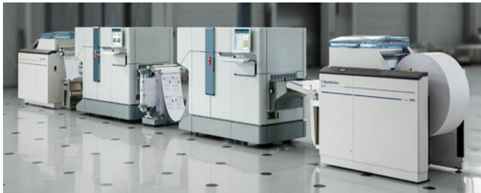
Slika 1: Sustav digitalnog tiska na pamučni tekstilni materijal
