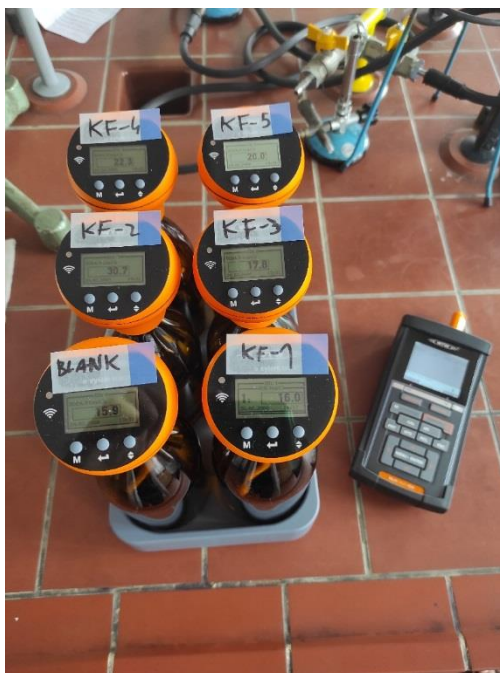
Slika 3.9. OxiTop set za mjerenje BPK vrijednosti u trenutku kada je mjerenje završeno
