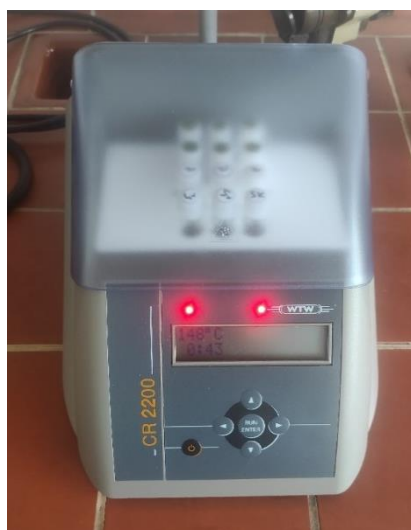
Slika 3.3. Termoreaktor u kojem se provodi reakcija refluksiranja
