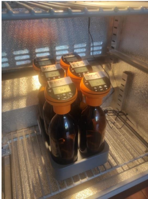
Slika 3.8. OxiTop set za mjerenje BPK vrijednosti u inkubatoru
