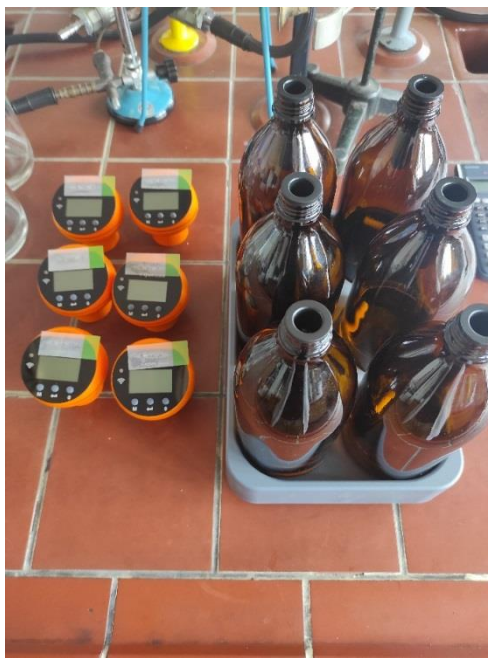
Slika 3.6. OxiTop set za mjerenje BPK vrijednosti
