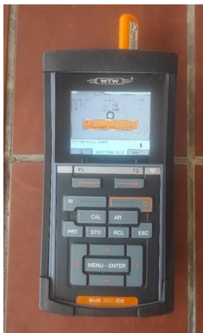
Slika 3.7. OxiTop Multi 3630/3620 IDS multimetar
