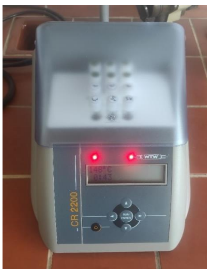
Slika 3.3. Termoreaktor u kojem se provodi reakcija refluksiranja
