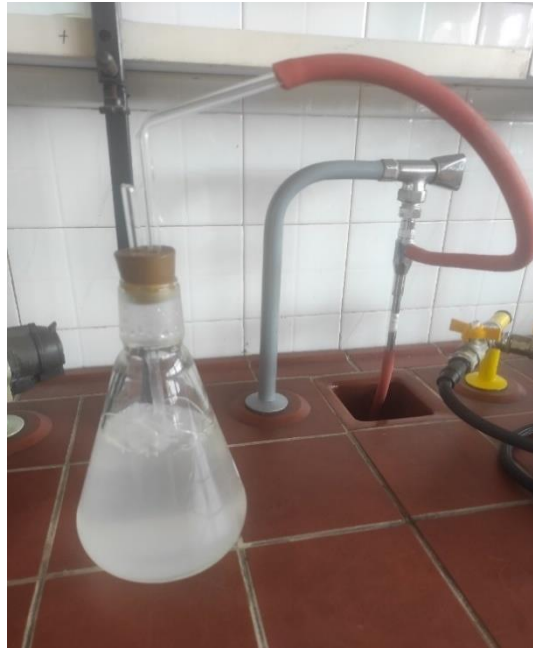
Slika 3.5. Aeriranje vode za razrjeđivanje
