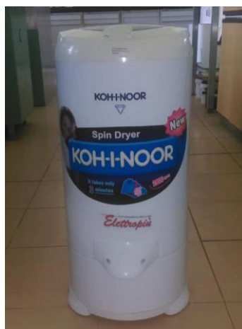
Slika 14. Stroj KOH-I-NOOR za centrifugiranje
