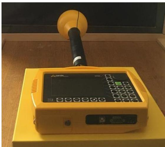
**Slika 20.** Mjerni instrument *NARDA SRM 3000*
