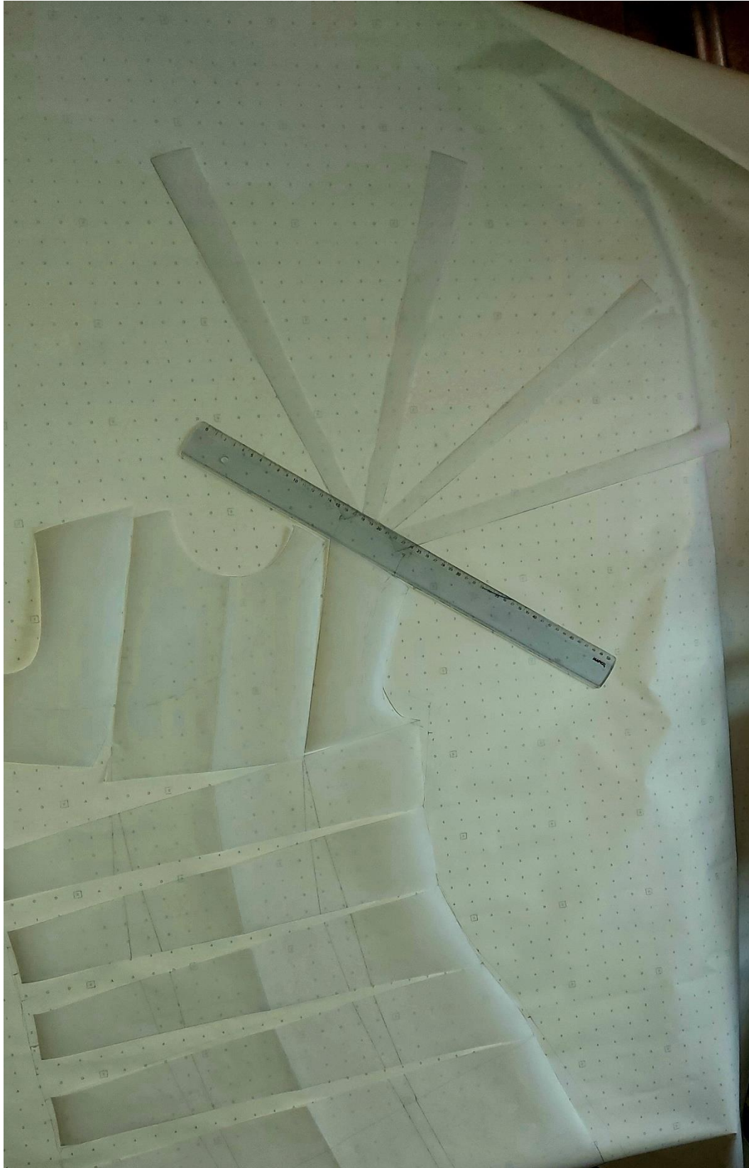
Sl.37. Modeliranje trake na ramenom šavu s desne strane prednjeg dijela haljine
