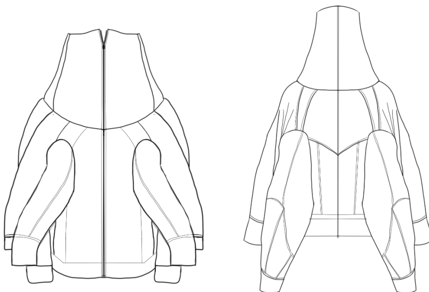
Slika 22. Tehnički crtež jakne s multipliciranim rukavima sprijeda (lijevo) i straga (desno) odjevne kombinacije 4
