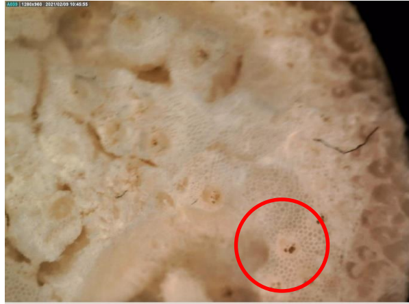
Slika 17. Morfološka analiza poprečnog presjeka stabljike Miscanthus gdje je vidljiv snop vlakana primjenom Dino-Lite svjetlosnog mikroskopa (40x)
