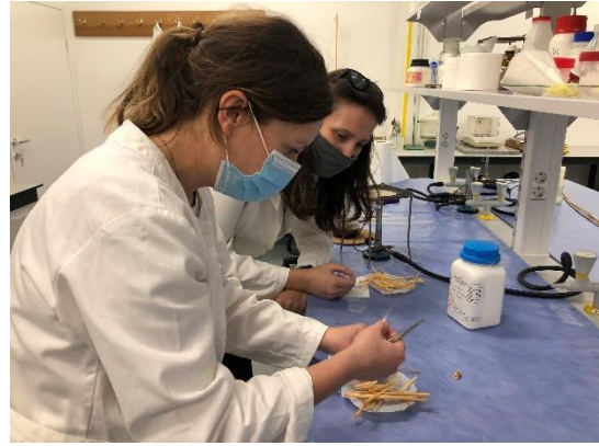
Slika 15. Uzorci Miscanthus x giganteus obrađeni u Kupelji 1 i 2 gdje su a) uzorci nakon sušenja i filtracije i b) uzorci prilikom izolacije vlakana
