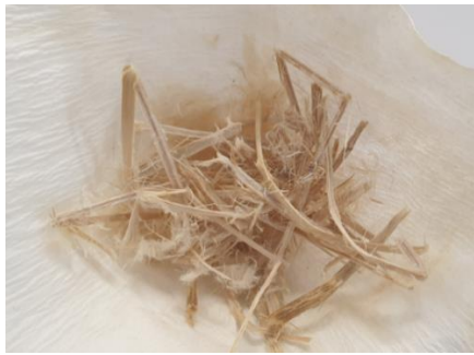
Slika 16. Uzorak Miscanthus x giganteus obrađen u Kupelji 3 gdje je a) uzorak nakon sušenja i filtracije i b) izolirana vlakna iz uzorka
