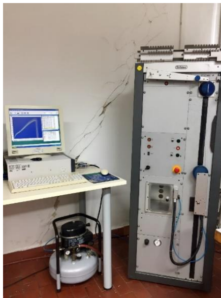
Sl. 4. Dinamometar Statimat M-tt. Textechno, Njemačka
