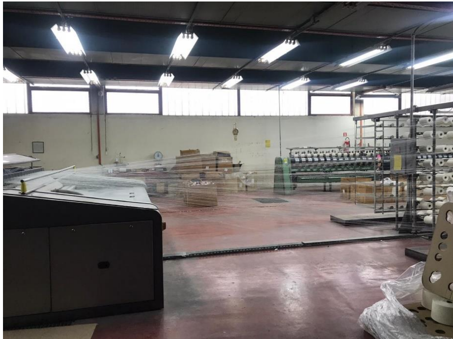
Sl. 10. Engleska snovaljka – razmak između stalka i stroja za snovanje
