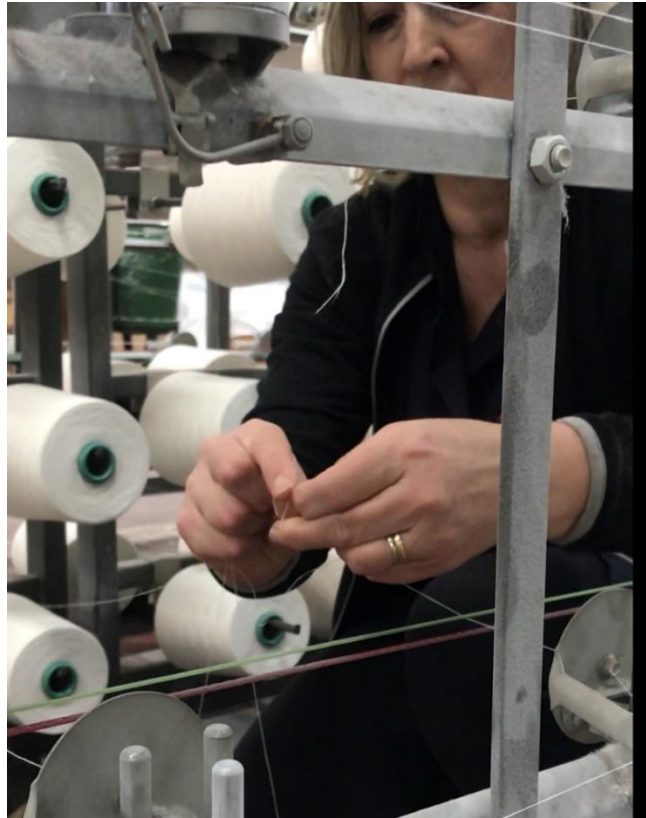
SI.8. Ručno vezanje niti kod stalka
