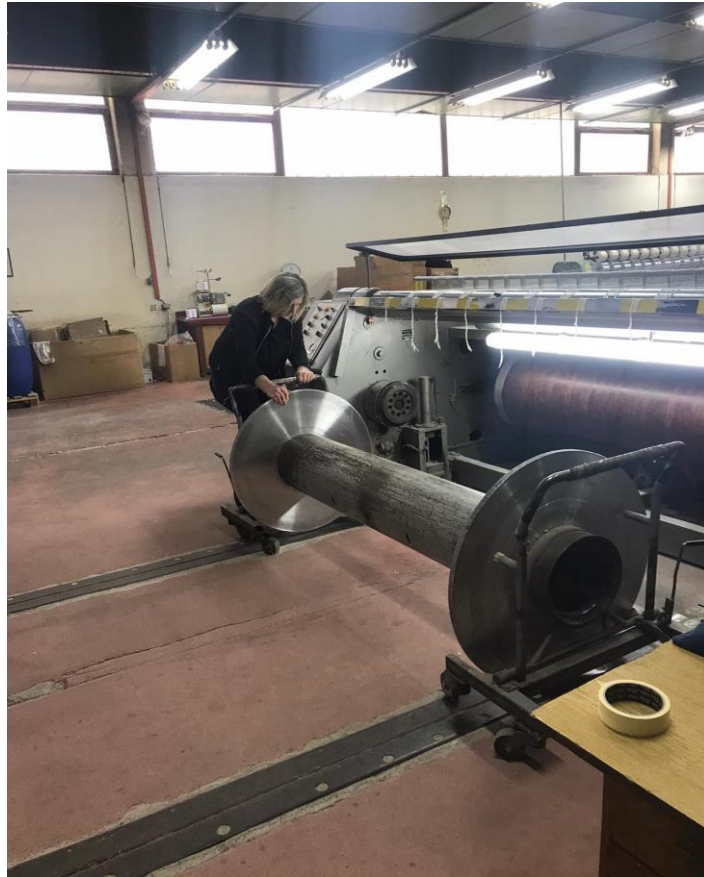
Sl. 17. Postavljanje praznog snovaćeg valjka s kolica na snovaljku
