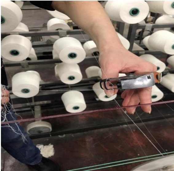
Sl. 14. Spajanje niti ručnim vezačem
