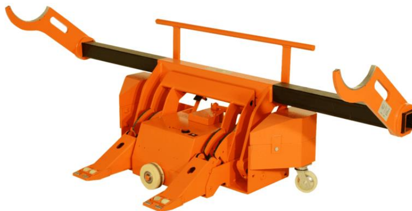
Sl. 6. Dizalica dizajnirana za transport valjaka [5]
