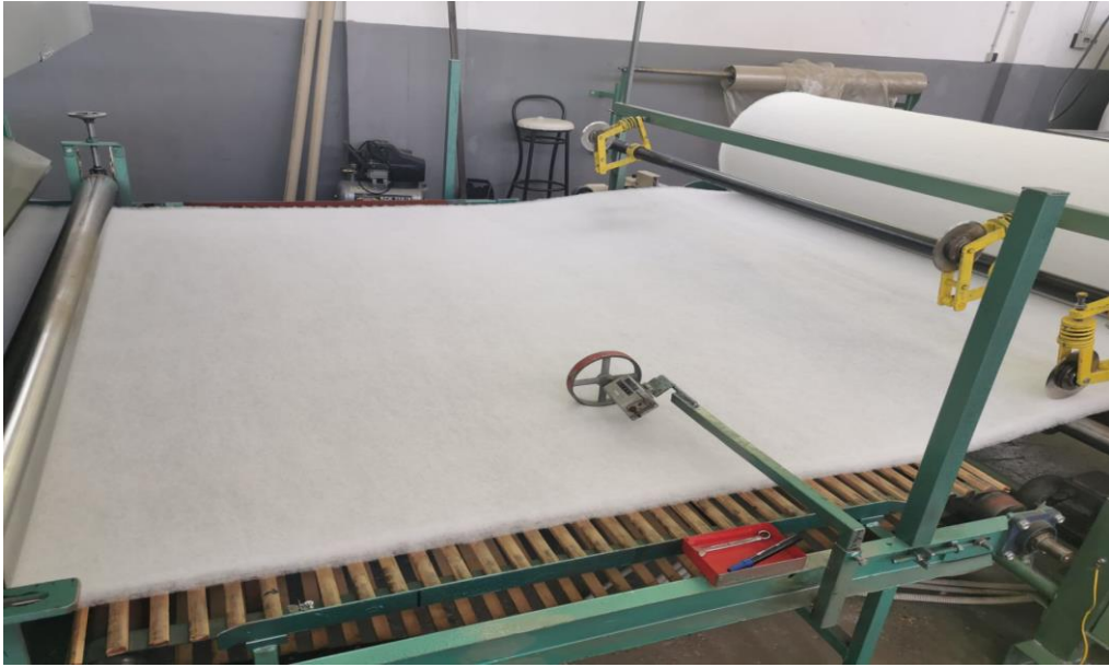
Slika 12 Namatanje netkanog tekstila u balu
