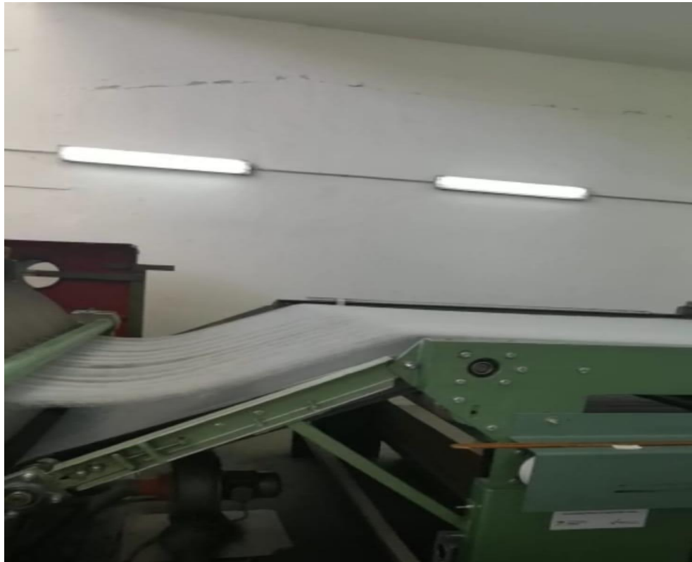
Slika 8 Dovod koprane na križni polagač
