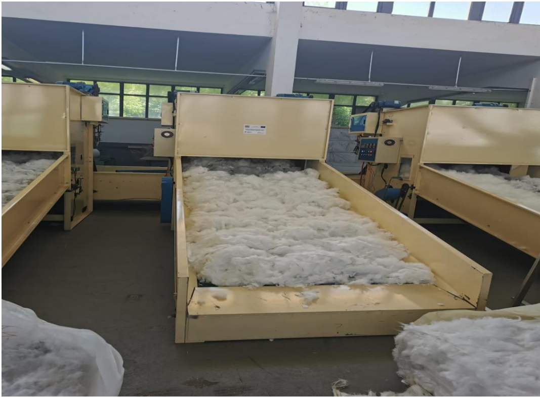
Slika 5 Snabdjevači (koševi hranioci); 3 ih ima i u svaki ide jedna komponenta/vrsta vlakana
