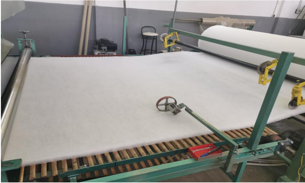
Slika 12 Namatanje netkanog tekstila u balu
