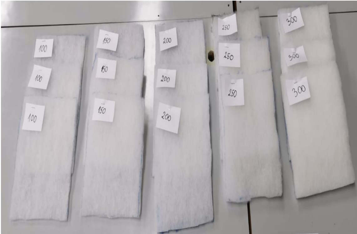
Slika 10 Izrezani uzorci različitih površinskih masa spremni za vaganje i mjerenje debljine
