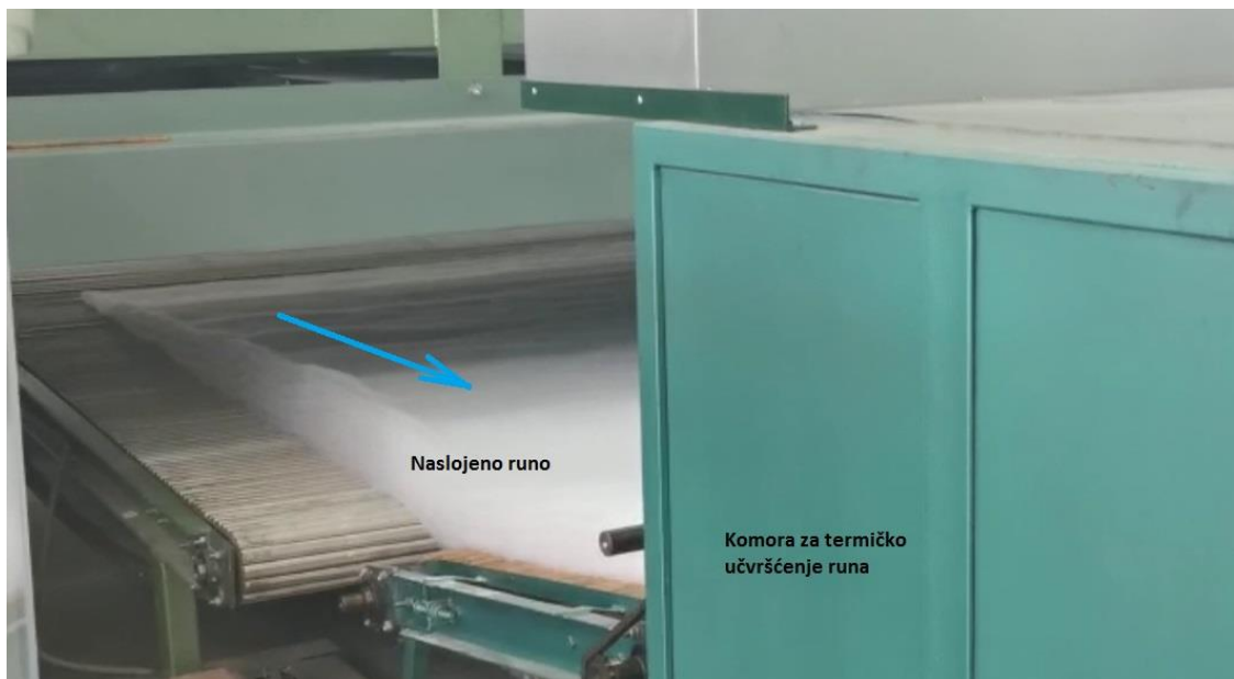
Slika 11 Termičko učvrščenje runa
